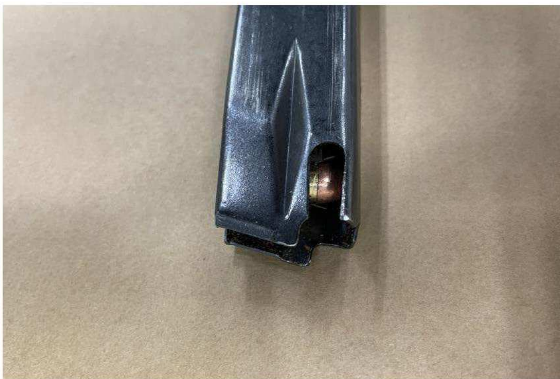
Figur 17. Det fanns en patron kvar i magasinet. Patronen satt tillsynes fast en bit ner.
