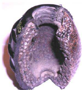
Bild 3 Genomskuren handgranatskropp med stålkulorna exponerade
