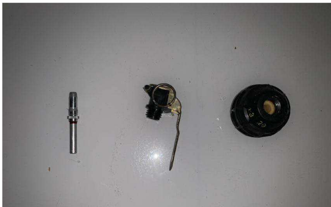
Figur 9. Handgranaten efter hela desapteringen.
