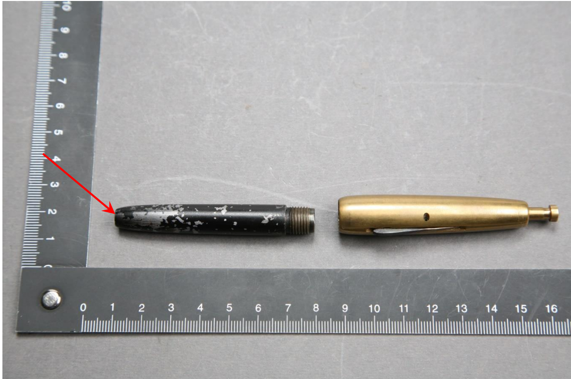
Foto 2. Studiofotografering av pennpistolen efter det att den delats. Pipmynningen på pennpistolen är markerad med röd pil. Se även foto 3.
