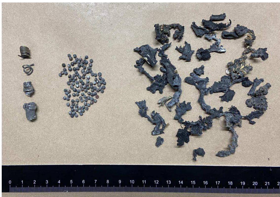
Figur 14. På hallgolvet anträffades metalledar, en fjäder, metallkulor och plastfragment (SM4941-13).
