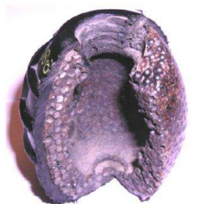
Bild 3 Genomskuren handgranatskropp med stålkulorna exponerade
