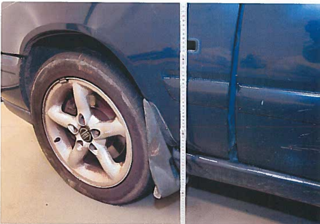
Bild 10. På vänster framskärm och chassit därunder sågs deformationsskador. Stänkskyddet i plats var demolerat. Skadorna bedömdes vara orsakade av något som tryckts upp under ifrån.
