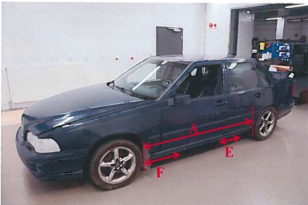
Bild 20. E= Bredden på skadorna var 53cm och de började 45cm framför hjulhuset. F= Bredden på skadorna var 80cm och började alldeles bakom hjulhuset.
