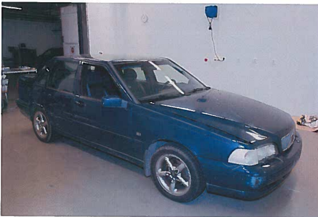
Bild 1. På bilens främre stötfångare på den högra sidan var färgen avskavd. Längs dörrarna och det bakre hjulhuset på höger sida fanns längsgående repor och färgavsättning på en höjd mellan ca 53 – 75 cm över marknivå.
