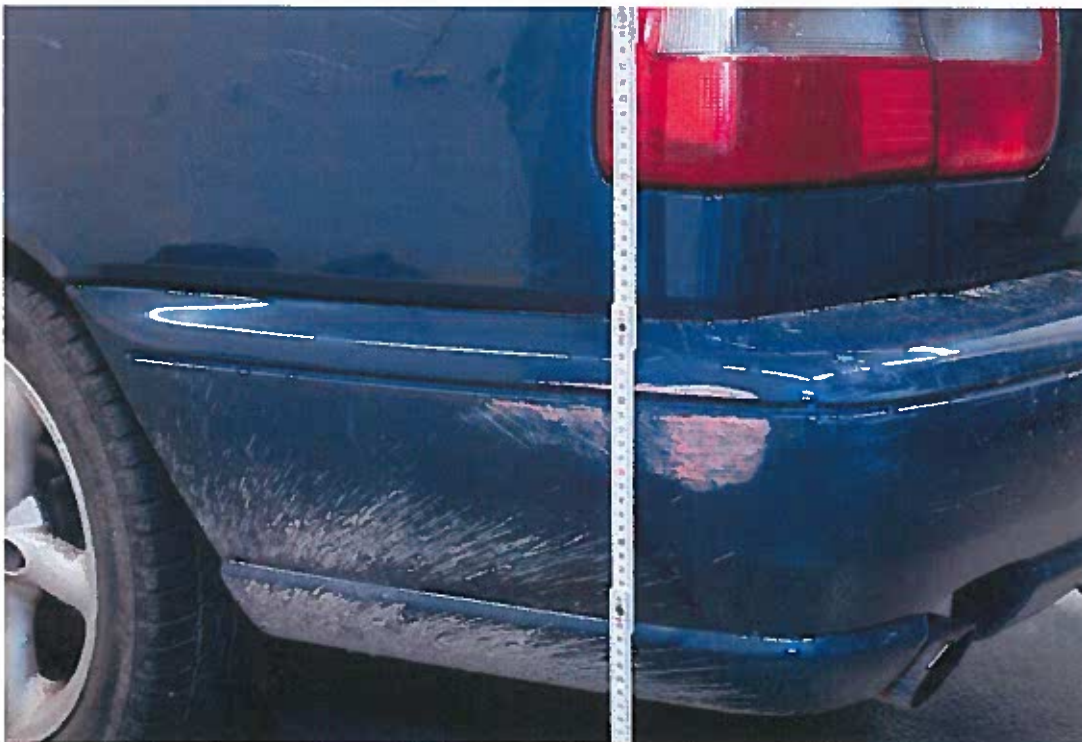
Bild 8. På den vänstra sidan av den bakre stötfångaren fanns röd färg. Bedömning gjordes att det är en äldre färgavsättning. Någon vidare undersökning av skadan har inte gjorts.
