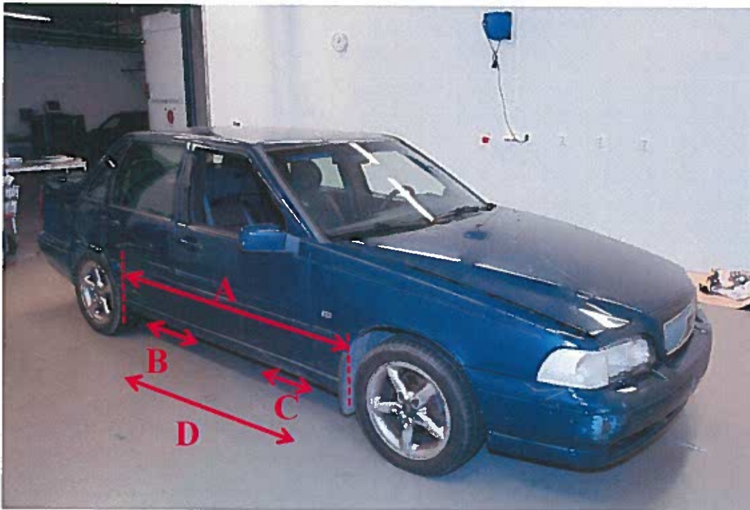
Bild 19. A= Avståndet mellan hjulhusen var 195cm. B= Bredden på skadorna var 35cm och de började 48cm framför hjulhuset. C= Bredden på skadorna var 40cm och de började 38cm bakom hjulhuset. D= Den totala bredden på skadorna var 110cm.
