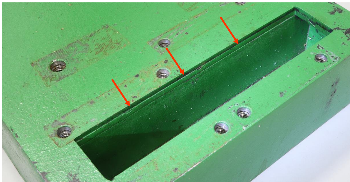
Bild 5. Bottenplattan var dubbelbottnad och man kunde se skåran (röd pil) på extra locket i fack på bottenplattan.
