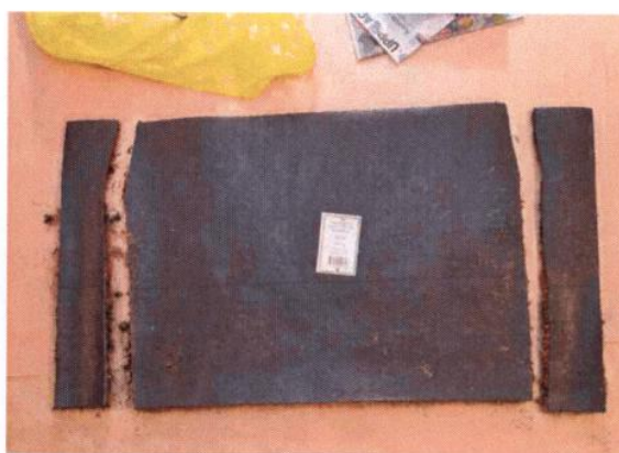
Bild 14 Undersidan av matta G003 med delvis uppluckrad gummbeläggning samt delarna som säkrats som brandrestprov.
