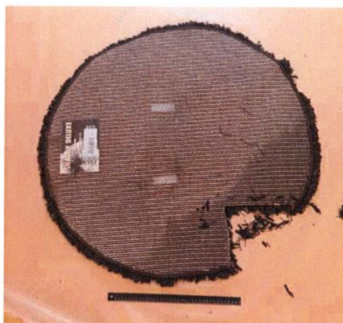
Bild 12 Undersidan av matta G002 där en del säkrats som brandrestprov.
