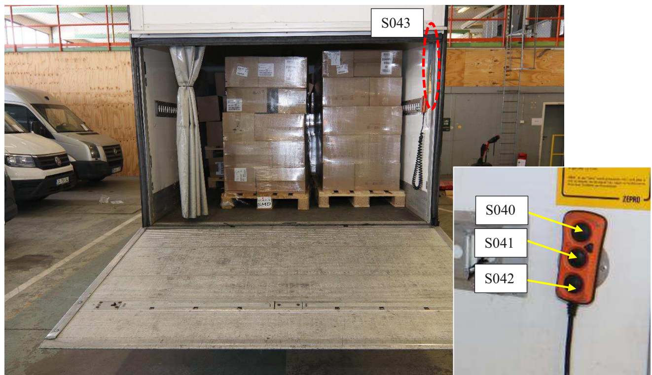
Figur 8. Rem (S043) till den övre luckan är markerad med röd oval. Infälld bild visar reglage (S040-S042) inne i lastutrymmet.
