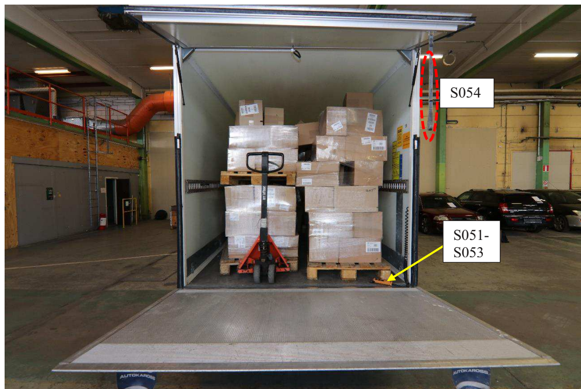
Figur 9. Rem (S054) till den övre luckan är markerad med röd oval och reglagen (S051-S053) inne i lastutrymmet är markerad med pil.
