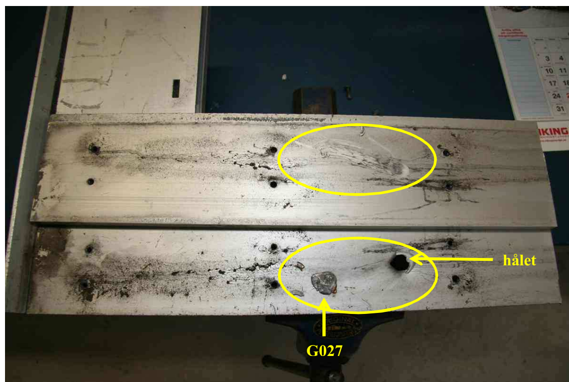
Bild 20. Metallramen vid skadan delades. Mellan dörrplåtarna, en bit nedanför hålet i metallen anträffades en tillplattad kula och metallfragment G027. Inom den övre ovalen ses motsvarande märken i smutsen som i den nedre ovalen där kulhålet och kulan ses.
