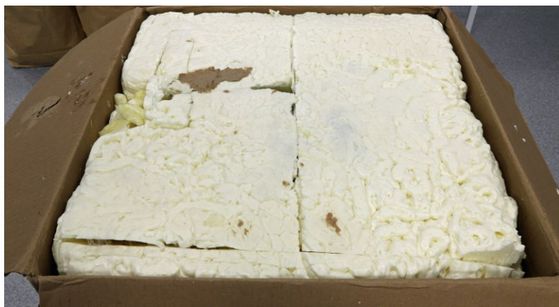
Bild 10. Originallocket av byggsaum byggdes ihop och ny fogsaum tillfördes för att täcka hålen.
