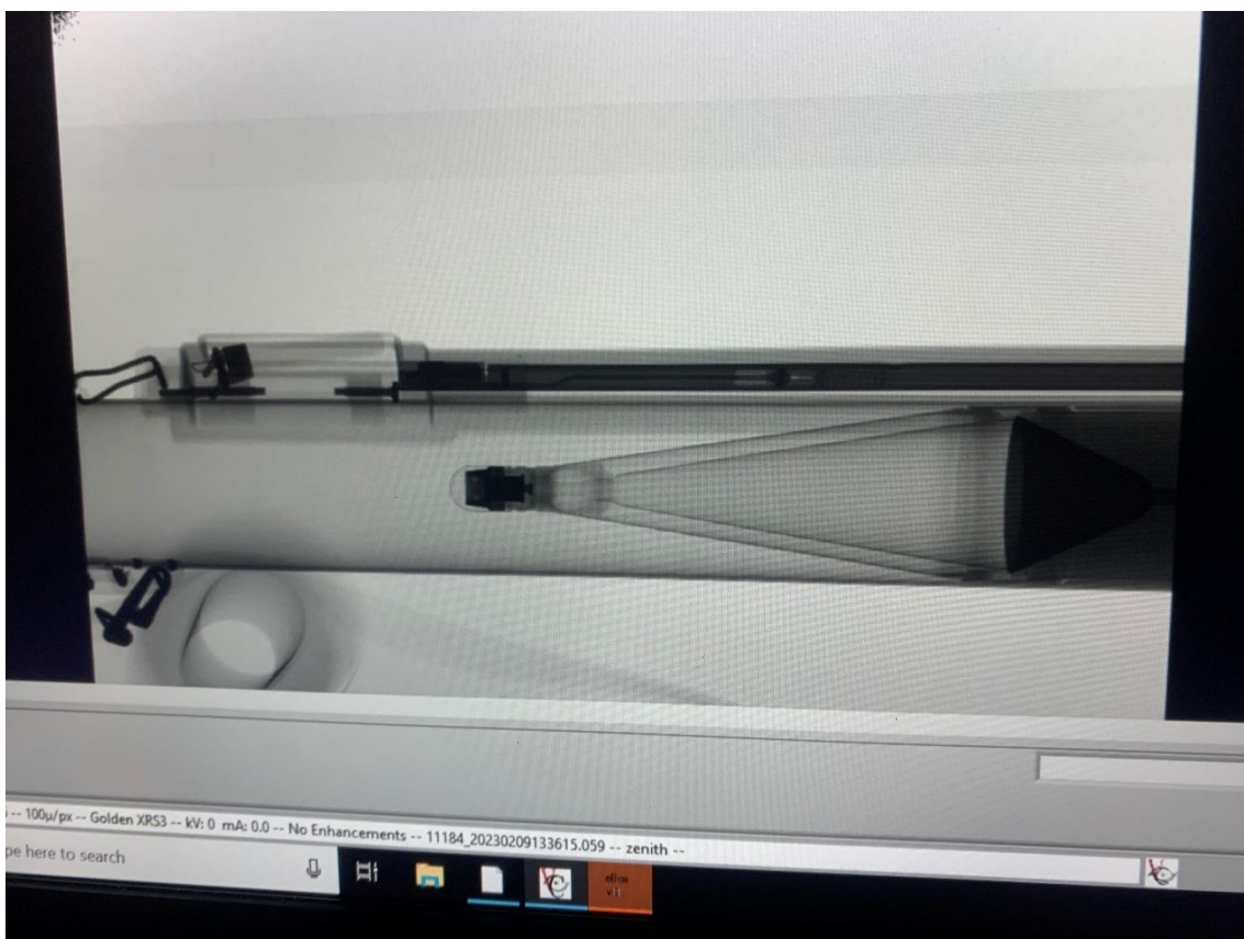
Röntgenbild på pansarskottets främre del.
