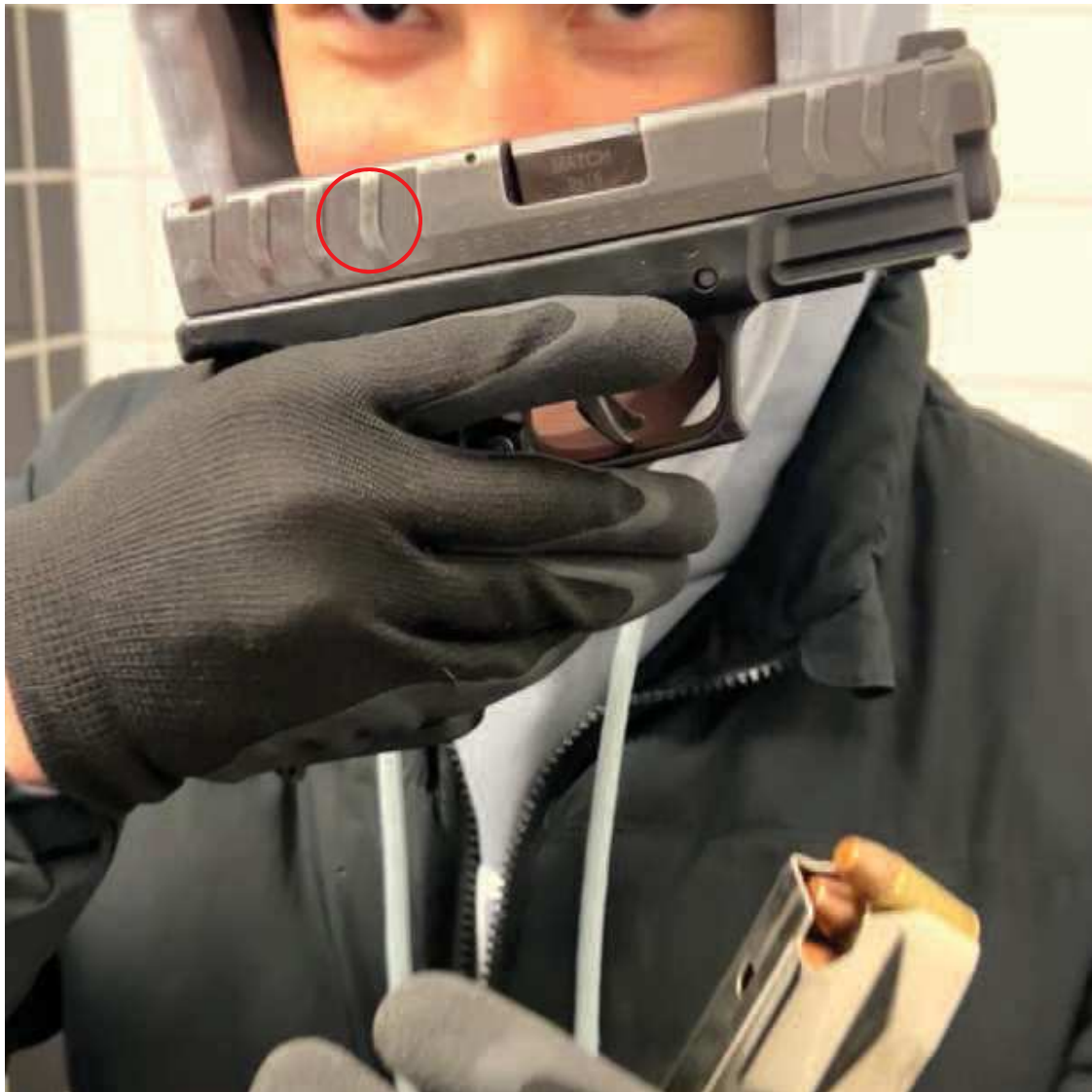
Bild 1. Fryst bild från filmen med förslitningsskador på manteln markerade med ring. I bilden ses även magasinet med patronerna.
