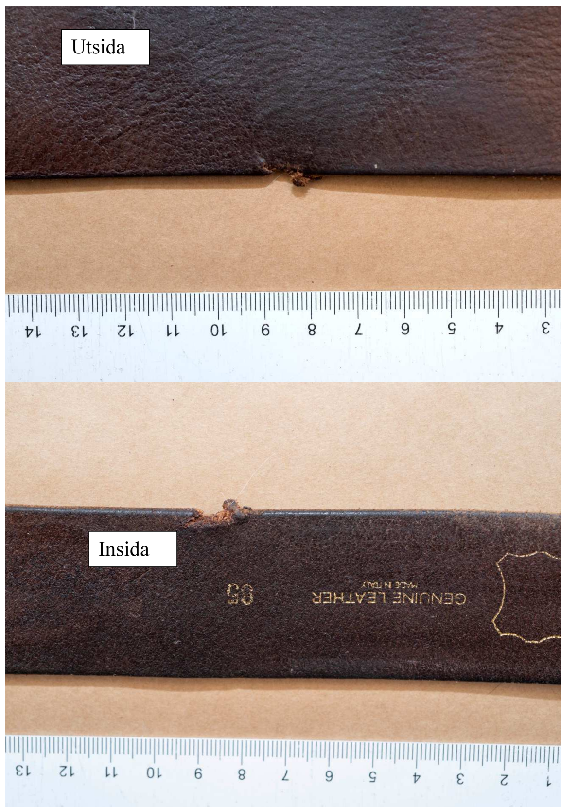
Bild 4. Skada ca 32 cm från spännet, fotat från utsidan resp. insidan.
