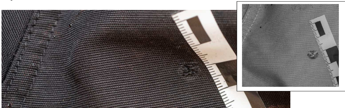
Bild 8. Nedre skada på brösttryggen, märkt "3" i bild 5. Infälld bild visar IR-foto.
