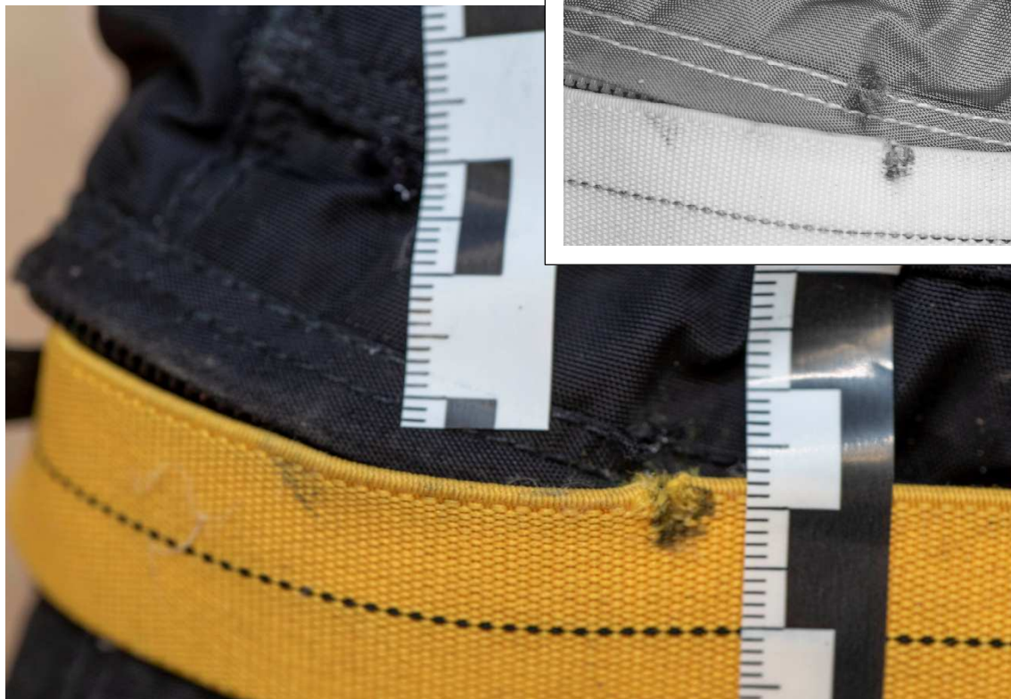
Bild 15. Skada på vänster sida under midjeresåren. Islag med skottrester syns tydligt på den gula detaljen och strax ovanför den fanns ett hål. Strax till vänster om den vänstra mättejpen fanns också ett hål. Infälld bild visar IR-foto.
