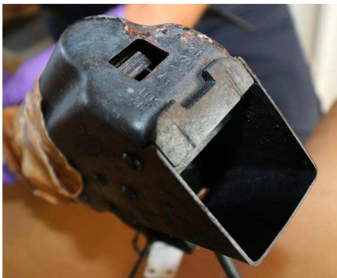
Bild 12. Ändstycket på BG44267-2 verkar vara kapat.
