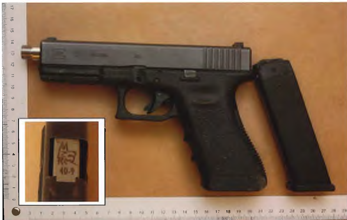
Bild 6. Beslag nr 2017-5000-BG74538-1, Glock mod 22, kaliber .40 (ca 10 mm), mantelnr KTY676. Vapnet är försett med en 9 mm pipa från Lone Wolf (40-9) som är något längre än vapnet för att t ex en ljuddämpare ska kunna monteras på vapnet.
