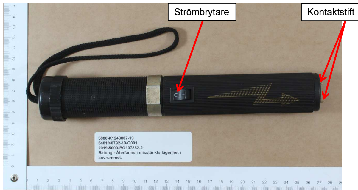
Bild 1. Beslag nr 2019-5000-BG107882-2 (G001), är ett elchockvapen i form av batong. Via en strömbrytare styrs strömen till kontaktstiften där en kraftig ljusbåge slår mellan kontaktstiften vid påslag av strömmen.
