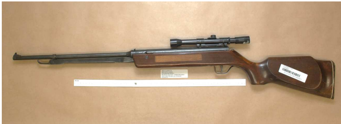
Bild 2. Beslag nr 2019-5000-BG108029-1 är ett luftgevär i kaliber 4,5 mm (.177) som laddas med diabololuftgevärskulor. Med armen under pipan spänns en fjäder som upphakas och vid avfiring trycken fram en kolv så att komprimerad luft trycker ut kulan ur pipan. Luftgeväret laddas med ett skott i taget.
