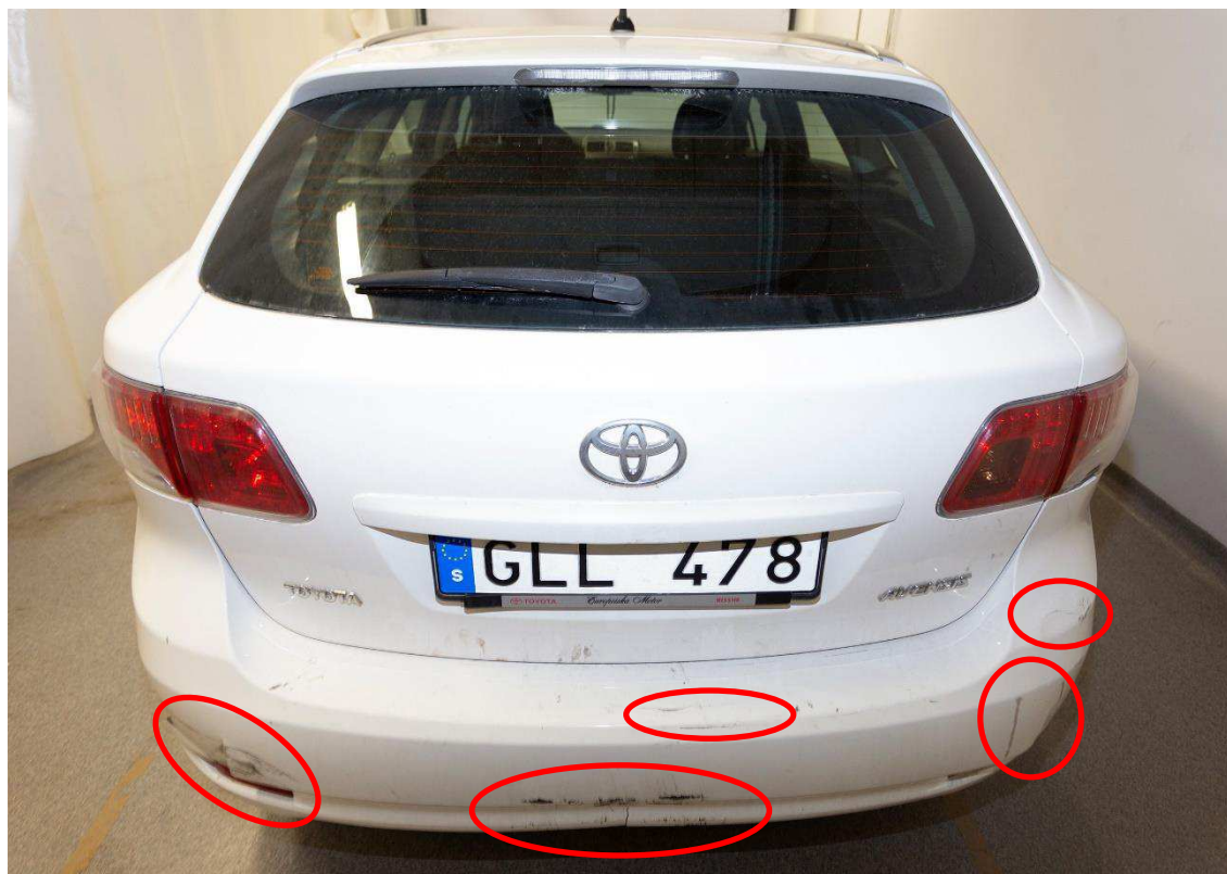
Figur 3. Personbil 2023-5000-BG49945-1, bak. Röda markeringar visar sprickor, bucklor och repor på stötfångare.
