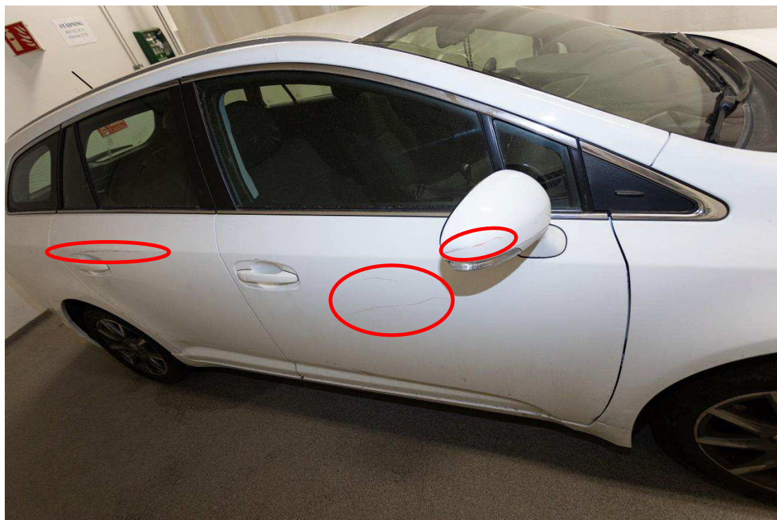
Figur 5. Personbil 2023-5000-BG49945-1, höger sida. De röda markeringarna visar repor i lacken.
