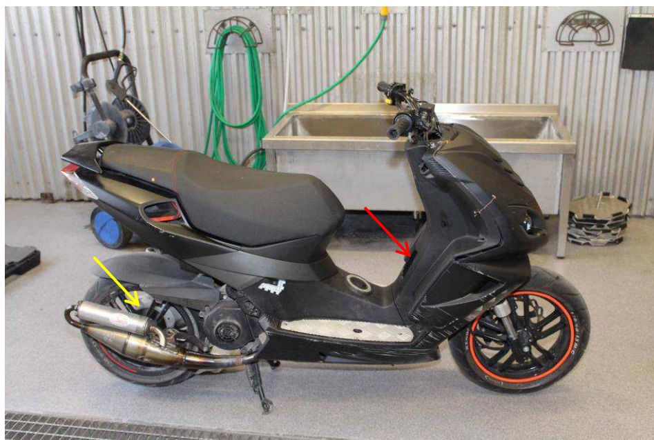
Bild 1. En röd pil utvisar var ramnumret kunde avläsas och en gul var motornumret kunde avläsas.
