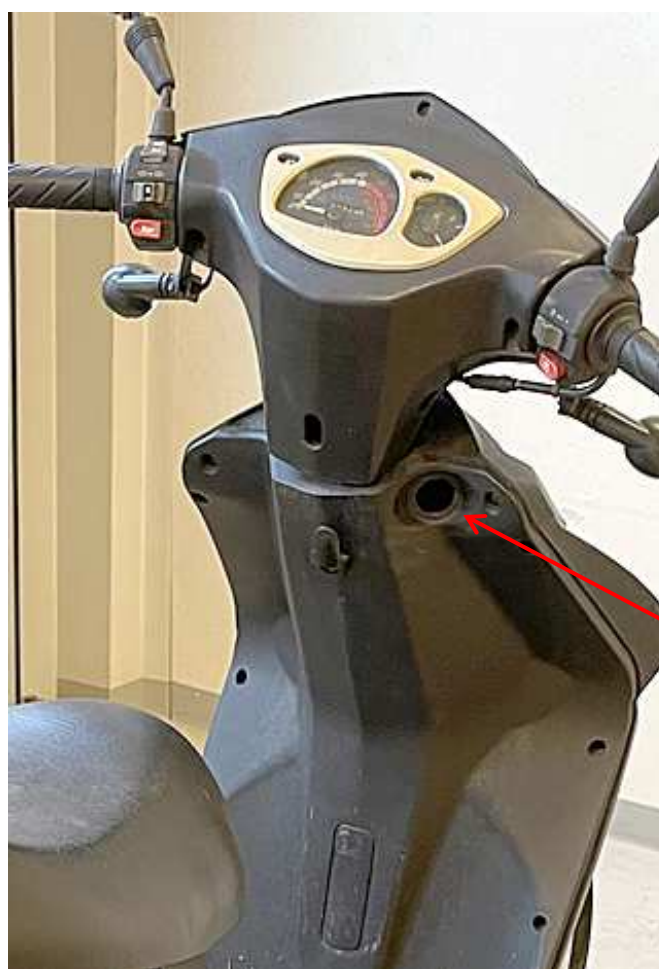
Figur 3. Visar hålet där tändningslås/styrlås suttit monterat.
