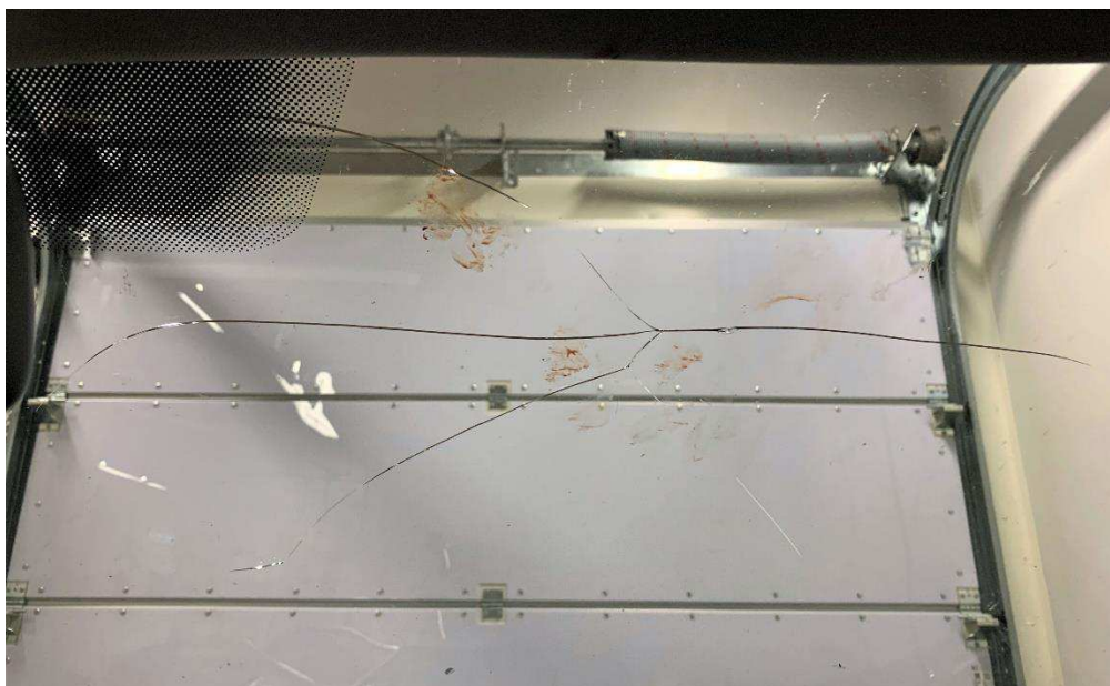
Figur 4. Sprickbildning samt blodbesudlingar i vindrutan framför passagerarplatsen.
