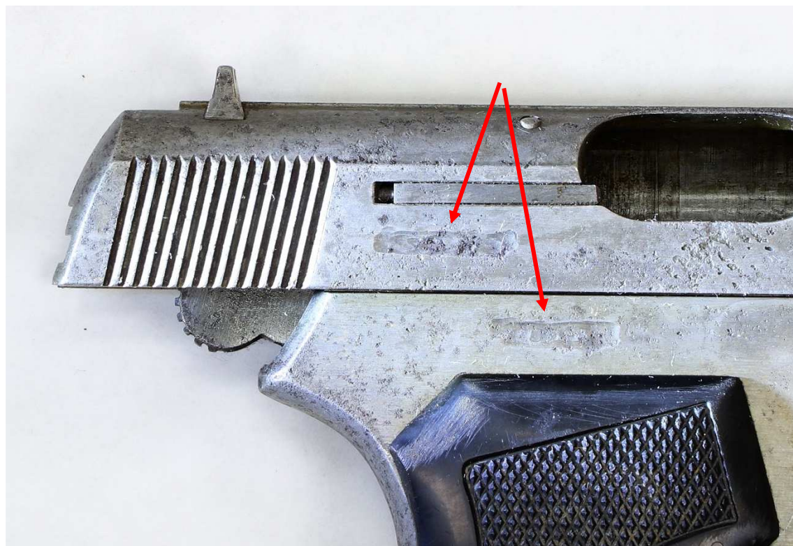
Figur 9. Visar närbild på bortskrapat/bortslipat vapennummer på mantel och stomme.
