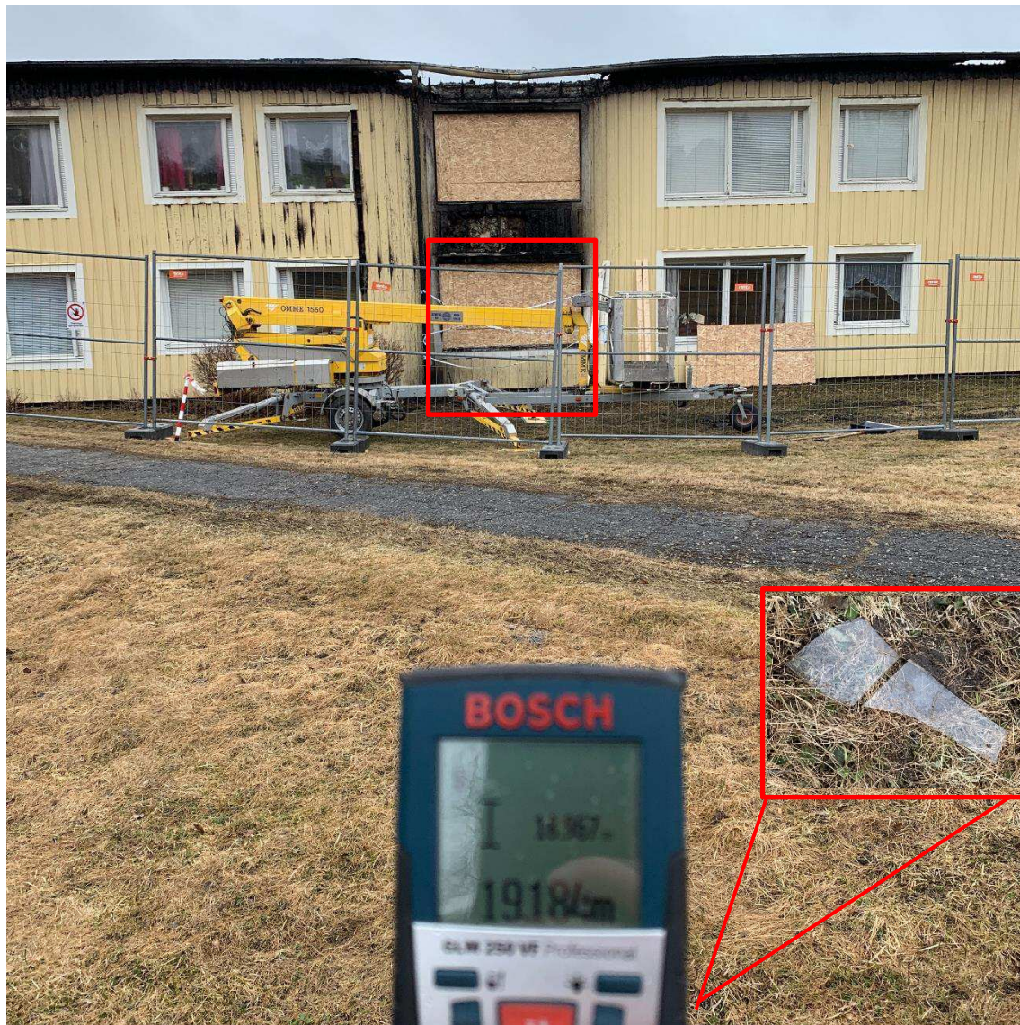
Figur 6. Bilden visar baksidan av Solbacken 2 C. Nederst i bild visar lasermätinstrumentet antal meter (ca 19) från fönstret till den glasbit som iaktogs längst ifrån den lägenhet som brunnit. Infälld bild i röd rektangel visar glasskärvorna.
