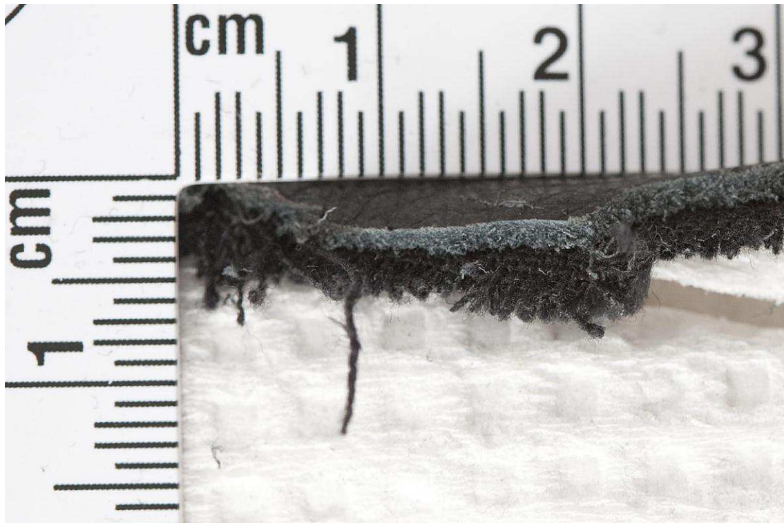
Figur 9 Bilden visar skinnjackans kant i uppförstoring består av skinn 1,5 mm tjocklek samt ett innerfoder 0,5 mm.
