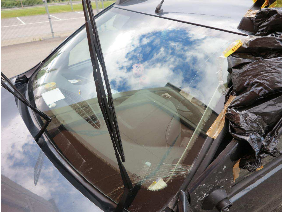
Figur 5 Framrutan har en horisontell spricka närmast vänstra förardörren. Förardörren i låst läge, går att öppna.
