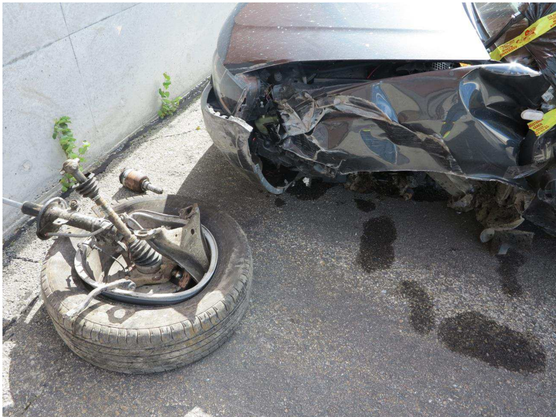
Figur 2 Fordonet har efter kollision (dikeskörning) tappat sitt vänstra framhjul. Kraftig intryckning av vänster framskärm samt vänstra framdörren.
