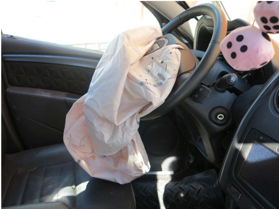
Figur 8 Bilden visar förarplatsen och den utlösta krockkudden.
