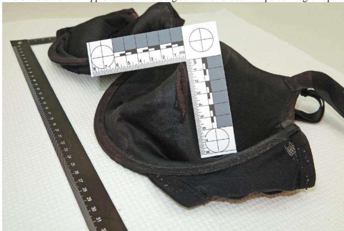
Figur 10. Skadan har gått rakt igenom tyget i kupan, fotot taget från Bh:ns insida. Skadan är ca 4 cm bred.
