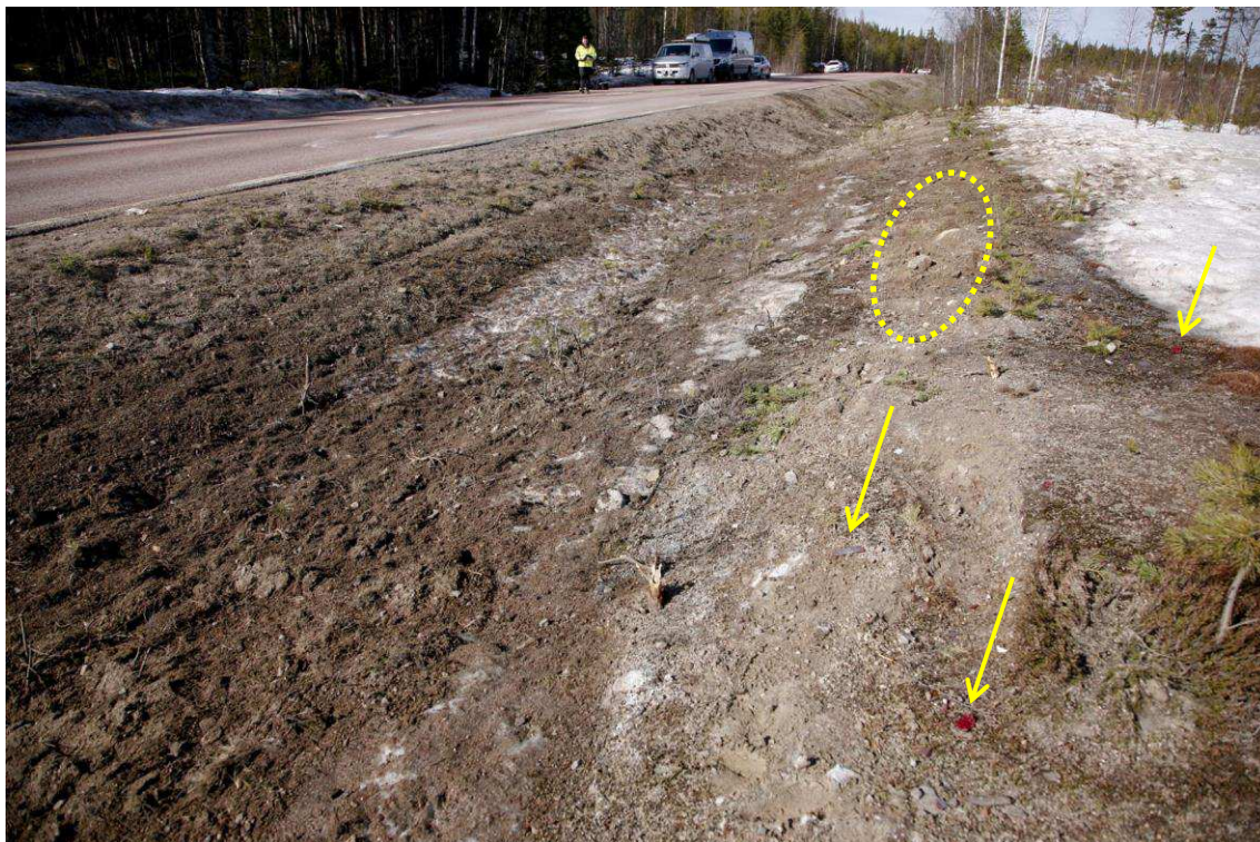
Figur 26. (Bild 6694) Samma område som i föregående figur (101-108 m norr om nollpunkten). Området med markpåverkan är inringat. Bitar av röda och vita reflexglas som kan ses på bilden är markerade med pilar. Inom detta område anträffades även bitar av gult plastglas, glassplitter, en nödutgångsskylt och strukturella glasfiber.
