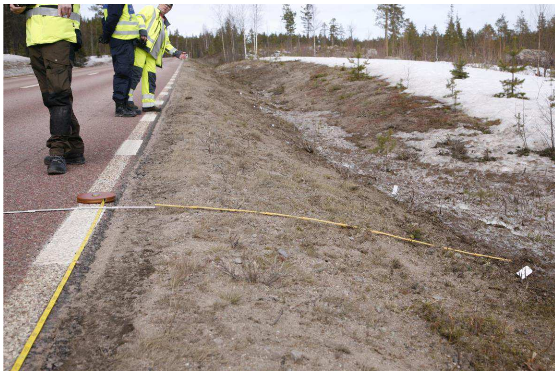
Figur 17. (Bild 6586) Ca 50 meter norr om nollpunkten. Avståndet mellan asfaltkanten och tumstockens högra kant där däckavtryckets högerkant iaktogs, mättes till ca 2,22 m.
