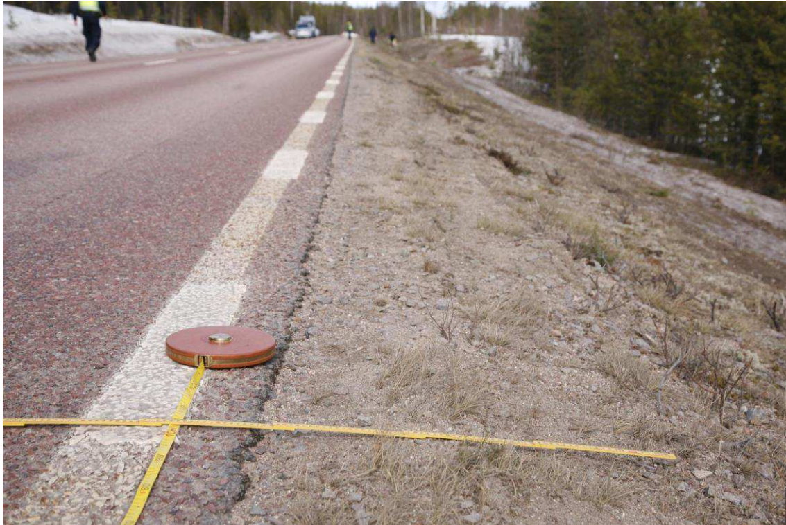
Figur 11. (Bild 6545) Ca 10 meter norr om nollpunkten. Avståndet mellan asfaltkanten och tumstockens högra kant där däckspårets högerkant iaktogs, mättes till ca 65 cm. Avåkningsvinkeln mätt från nollpunkten till 10 meter är ca 2 grader. Avåkningsvinkeln, mätt mellan nollpunkt och 40 meter, är även den ca 2 grader. Nivåskillnaden mellan stödremsan (gruset) och asfalten är ca 2 cm.
