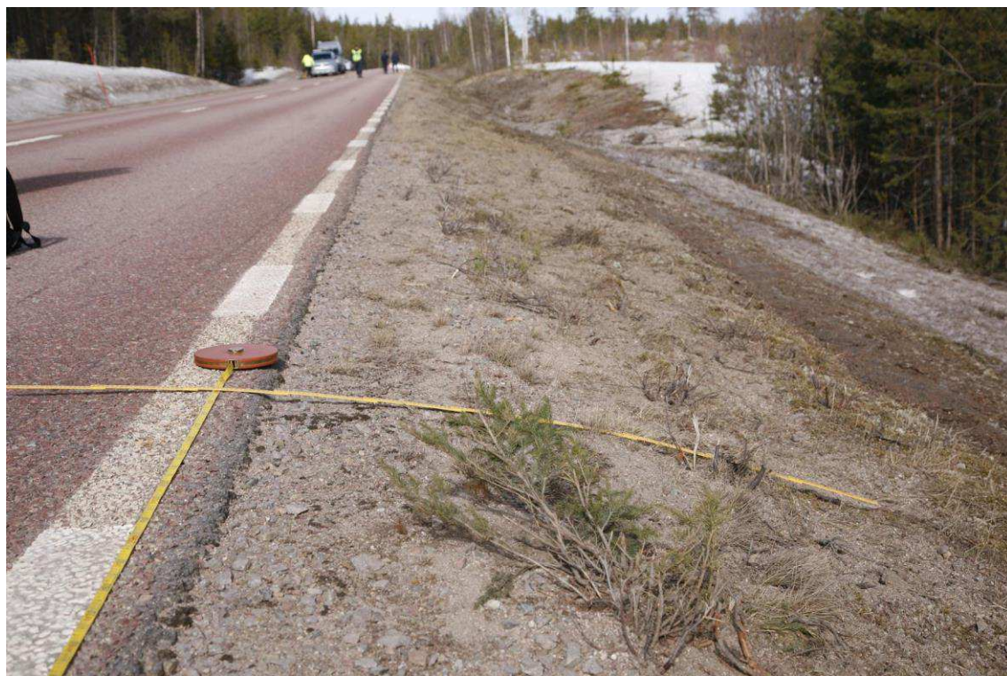
Figur 13. (Bild 6559) Ca 30 meter norr om nollpunkten. Avståndet mellan asfaltkanten och tumstockens högra kant där däckavtryckets högerkant iaktogs, mättes till ca 1,43 m.
