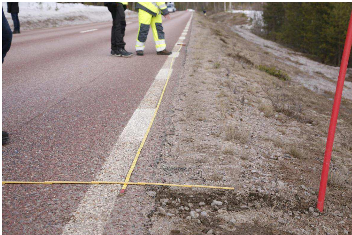
Figur 10. (Bild 6538) Asfaltkanten har hela tiden använts som utgångspunkt för mätningarna i sidled. Vid nollpunkten iaktogs spår från ett däckavtryck, där spårets högerkant mättes till att vara ca 33 cm till höger om asfaltkanten, som tumstockens ytterkant visar på bilden.
