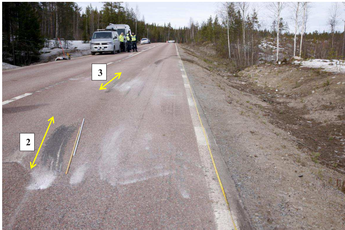
Figur 28. (Bild 6652) Vid den nedre dubbelpilen ses samma rivspår (nr 2) som i föregående figur, sett ifrån körbanan i norrgående riktning. Spår nr 2 mättes till ca 2,3 m. Efter ett uppehåll på ca 3,5 m, börjar ett annat svartfärgat spår med rivmärken (nr 3). Spår nr 3 mättes till ca 4 m långt och markeras i figuren av den övre dubbelpilen.
