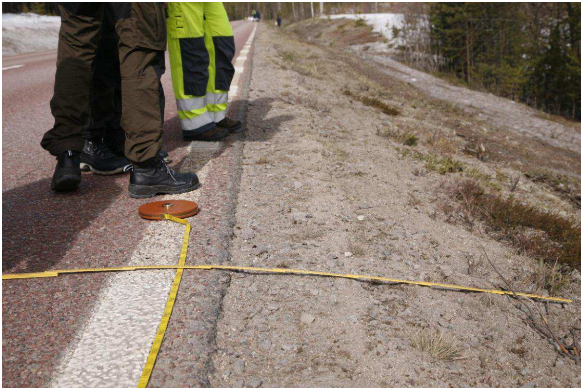
Figur 12. (Bild 6551) Ca 20 meter norr om nollpunkten. Avståndet mellan asfaltkanten och tumstockens högra kant där däckavtryckets högerkant iaktogs, mättes till ca 93 cm.
