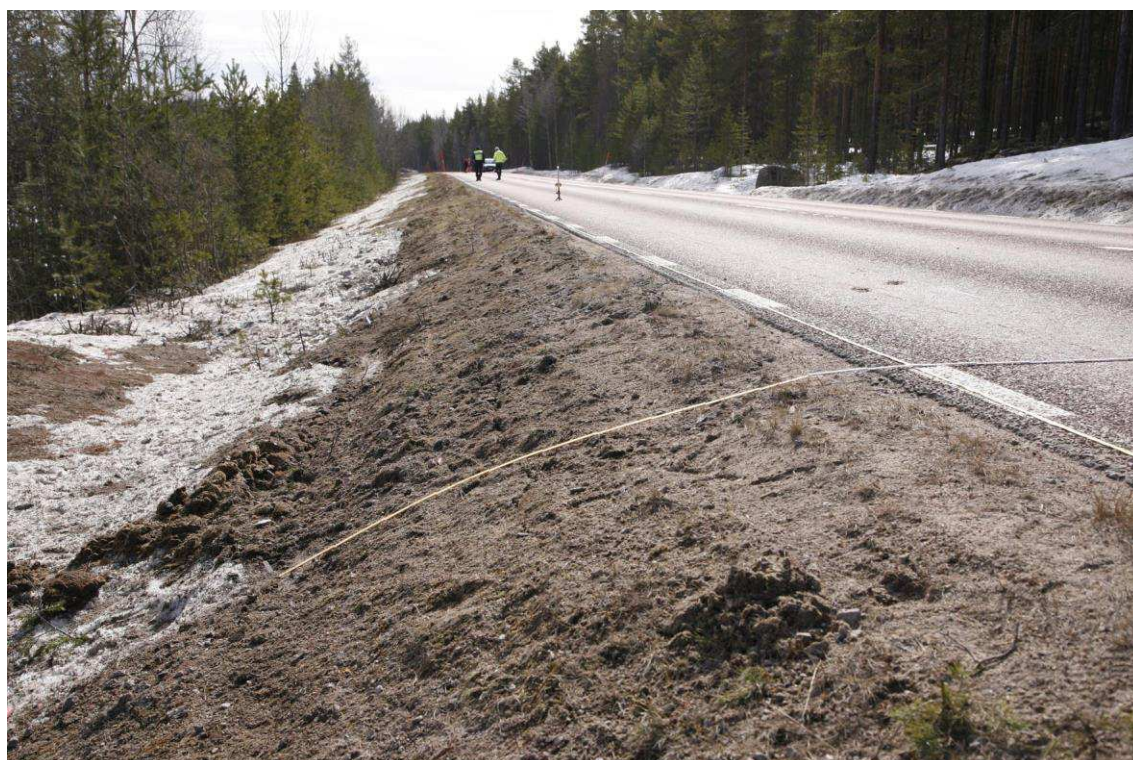
Figur 20. (Bild 6505) Ca 70 meter norr om nollpunkten, med vy i riktning söderut. Avståndet mellan asfaltkanten och tumstockens vänstra kant enligt bild, där däckavtryckets högerkant (i färdriktningen) iaktogs, mättes till ca 2,27 m. I området mellan ca 60-70 meter från nollpunkt, finns den brantaste lutningen i vägrenen, som uppmättes till ca 24 graders vinkel.
