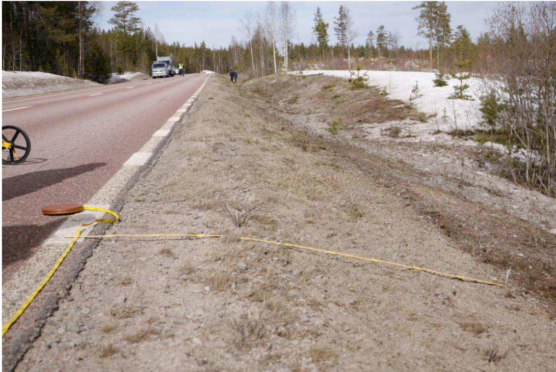
Figur 15. (Bild 6575) Ca 40 meter norr om nollpunkten. Avståndet mellan asfaltkanten och tumstockens högra kant där däckavtryckets högerkant iaktogs, mättes till ca 1,83 m.
