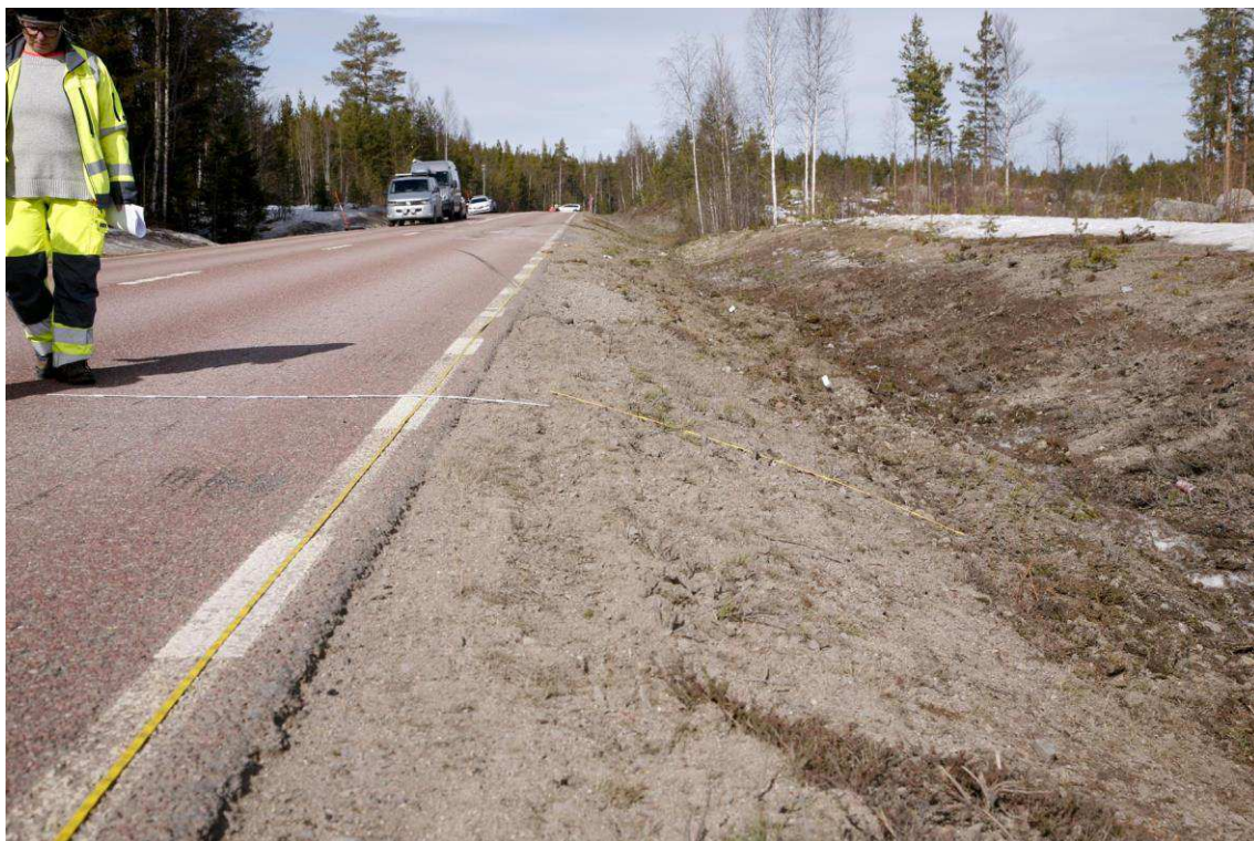
Figur 22. (Bild 6617) Ca 80 meter norr om nollpunkten. Avståndet mellan asfaltkanten och tumstockens högra kant där kontaktspar som bedöms vara från någon del av bussen, mättes till ca 2,35 m.
