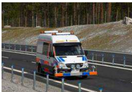
Figur 3: NCC's mätbil av typ GE Profilograf
