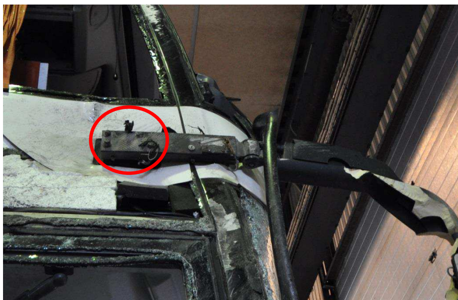
Figur 17. Infästningen av höger sidospegel. Skruvarna är inringade i bild.
