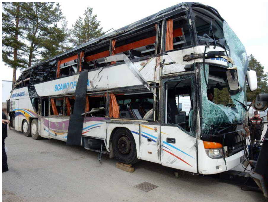
Figur 14. Skadorna på bussen var lokaliserade till den högra sidan. Många rutor på den högra sidan var krossade. Den övre framrutan har lossnat ytterligare under transporten av bussen.
