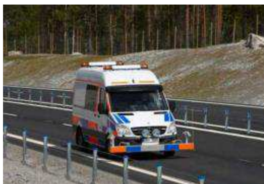
Figur 1: NCC's mätbil av typ GE Profilograf
