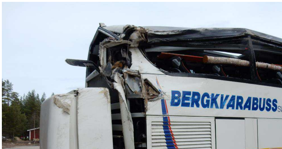
Figur 16. Deformationen på den bakre delen av bussen. Trädet som är inkilat i passagerarutrymmet sattes dock dit för att användas vid bärgningsinsatsen.
