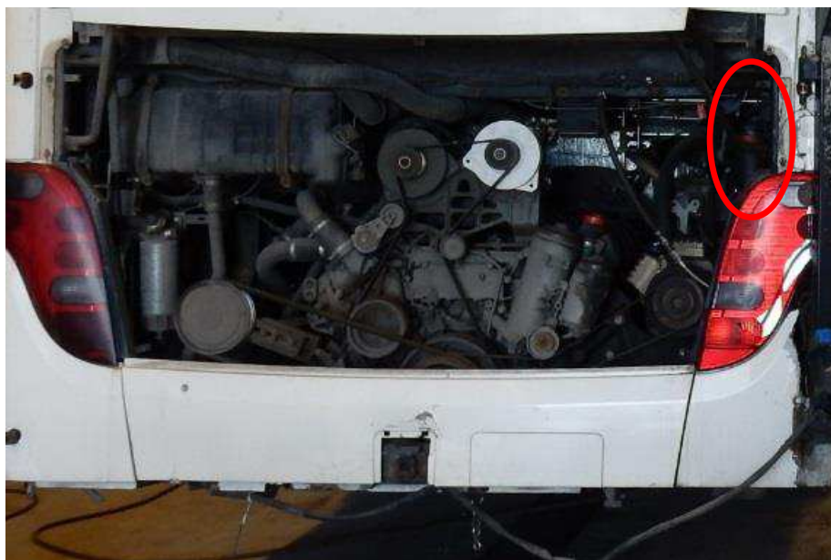
Figur 19. Oljebhållarens placering i bussens motorutrymme.
