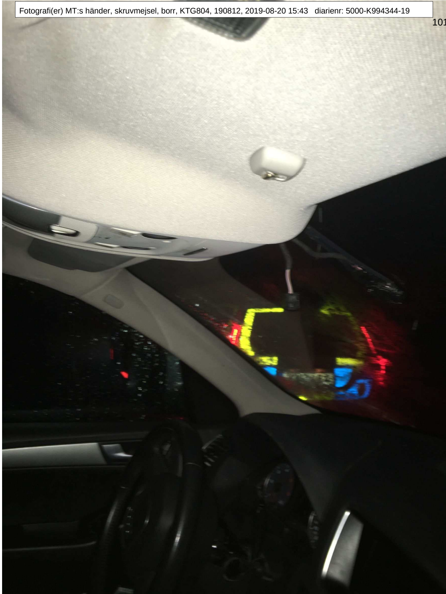
Avsaknad av mittspegel. KTG804
