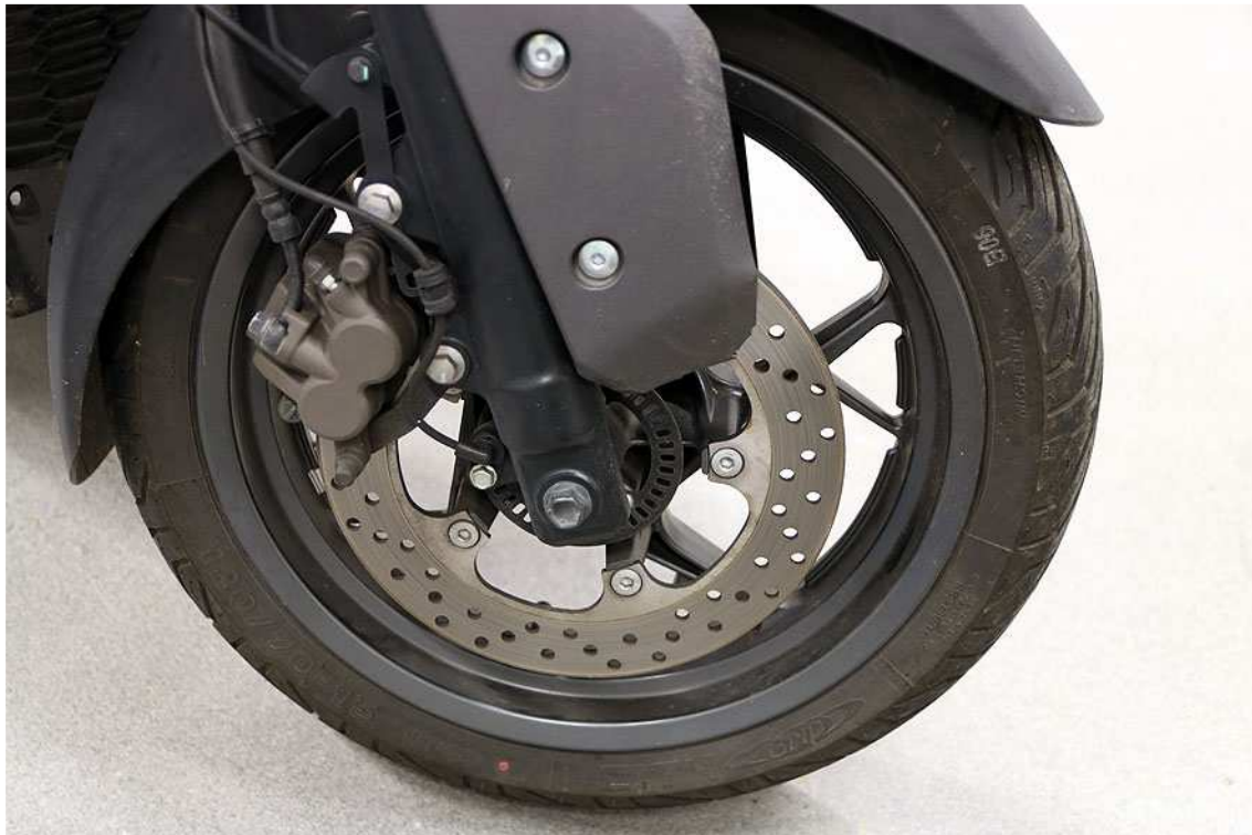
Figur 12. Framhjul/bromsskiva höger sida utan uppenbara skador.
