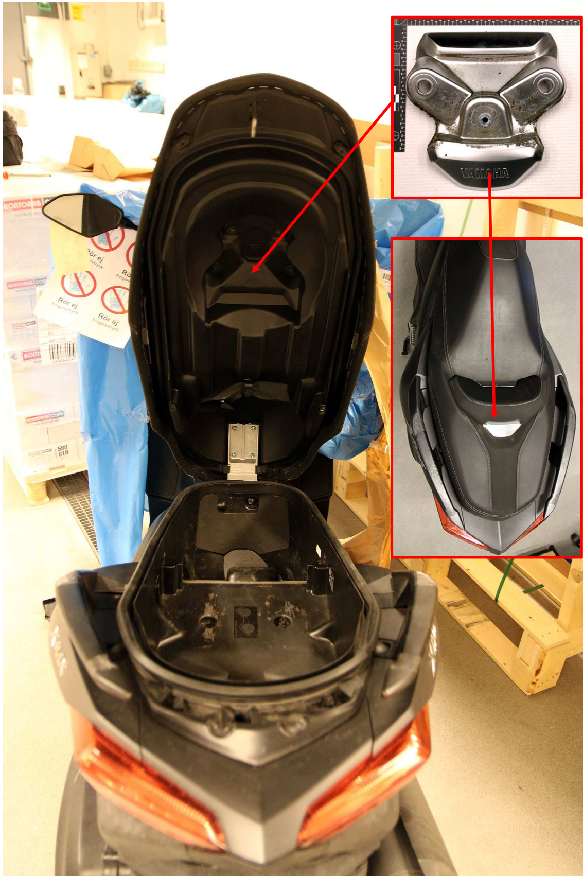
Figur 7. Här är sadeln öppnad. Infällda bilden uppe till höger visar den metalledalj med beslagsnummer 2022-5000-BG113816-1 som normalt sett är monterad på ovansidan av sadeln men skruvas fast från insidan vid plats som visas i stora bilden. Metalledaljens placering på ovansida av sadel syns i nedre infällda bilden.
