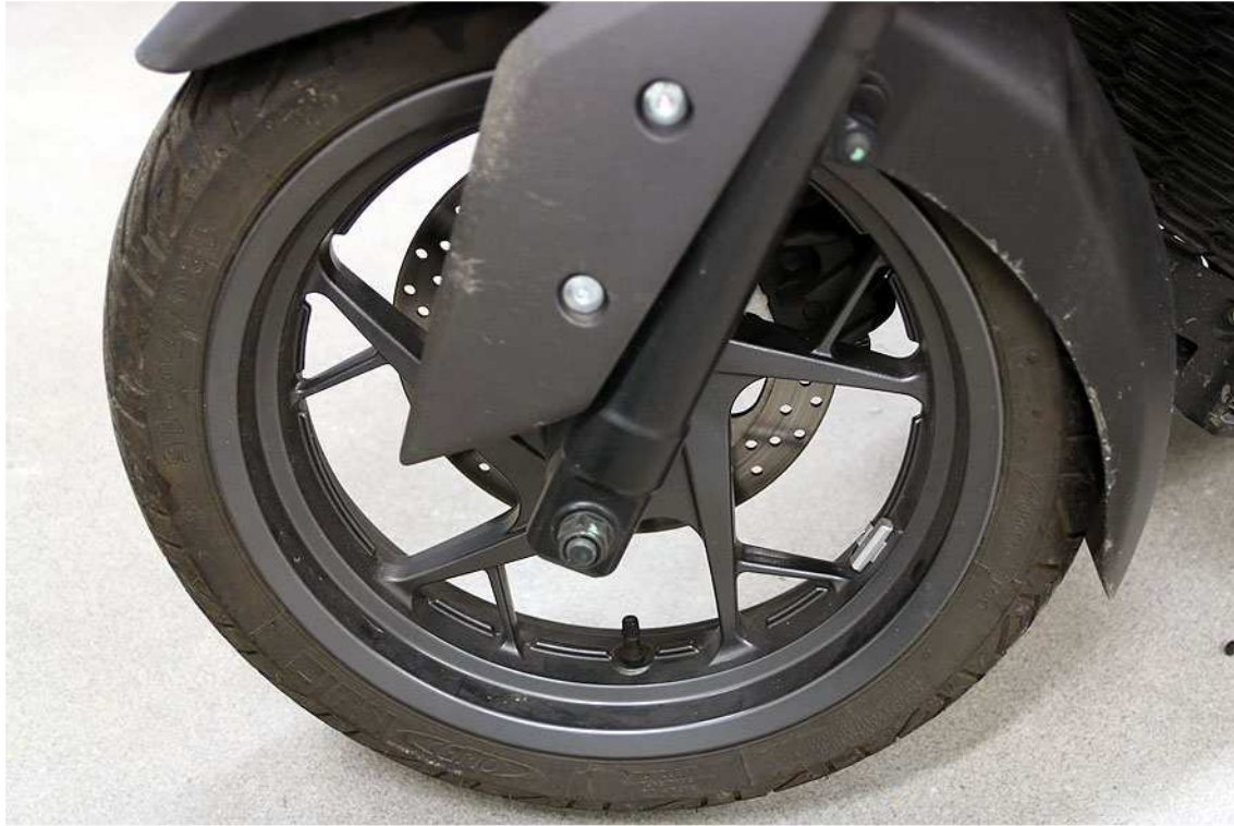
Figur 11. Framhjul vänster sida utan uppenbara skador.
