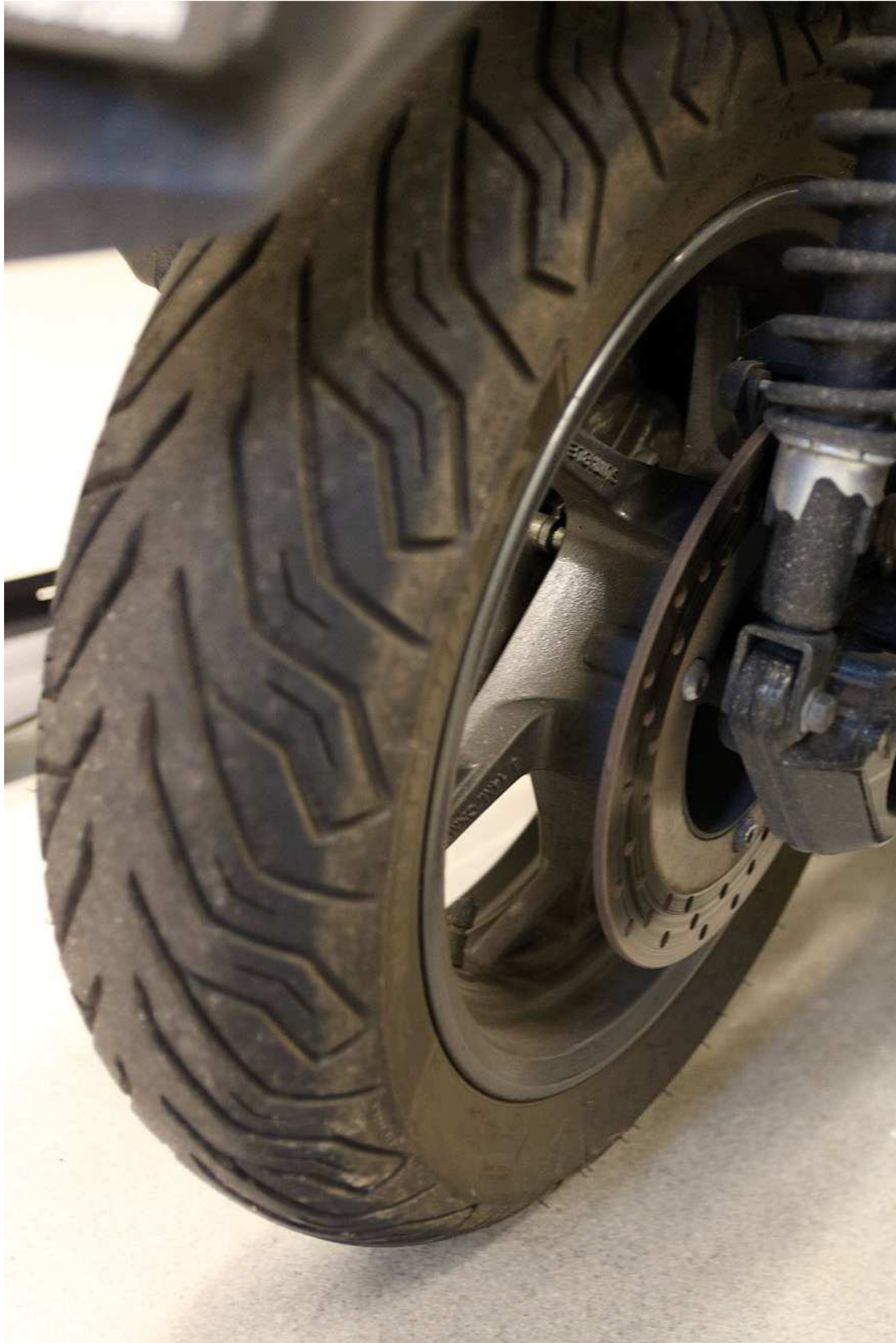
Figur 16. Bakhjul och bromsskiva utan uppenbara skador.
