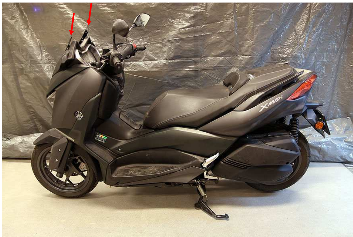
Figur 21. Mc:n och dess vänstra sida. Hållarna till saknad vindavvisare/vindruta är här monterade något högt. (Röda pilar i bilden) Rätt monterade visas i figur 24.
