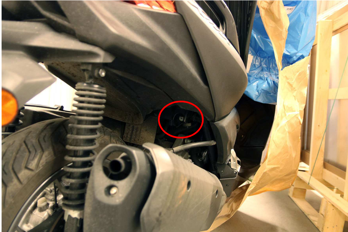
Figur 5. Normalt sett öppnas förvaringsfacket under sadeln elektroniskt. Vid undersökningen saknades denna möjlighet varför försök gjordes med reservalternativet nyckellås som är placerat under sadeln (se röd markering i bilden).
