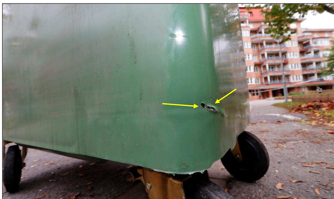
Figur 11. Närbild över skadan i sopkärlets nedre hörn, som stod placerad in mot den bakre väggen och kortväggen inne i sopstationen. Skadan är utmarkerad med pilar i bilden.
