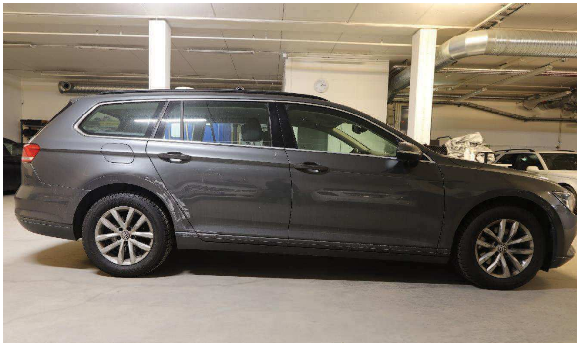
Figur 1. Höger sida av personbil JPX39T med en plåtskada till höger av det bakre hjulhuset som går över på baddörren.
