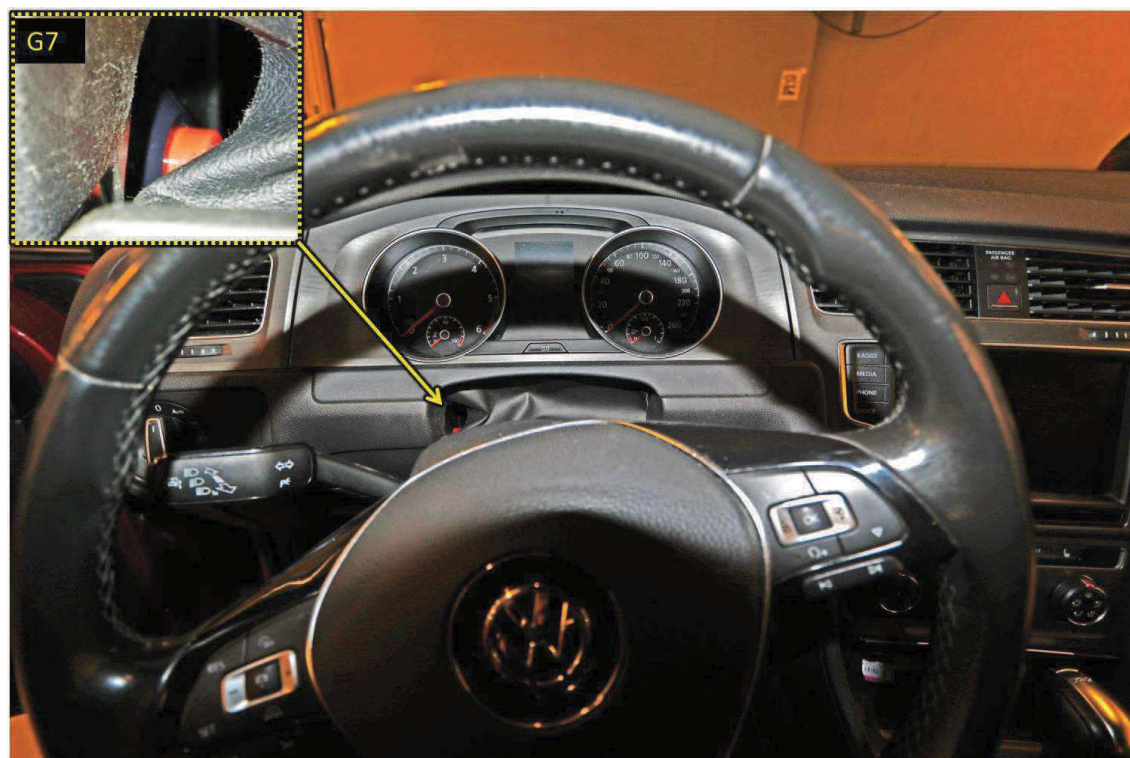
Figur 6: Bilden visar ratten som har tiltats nedåt och till vänster om rattstängens syns en röd knapp.
