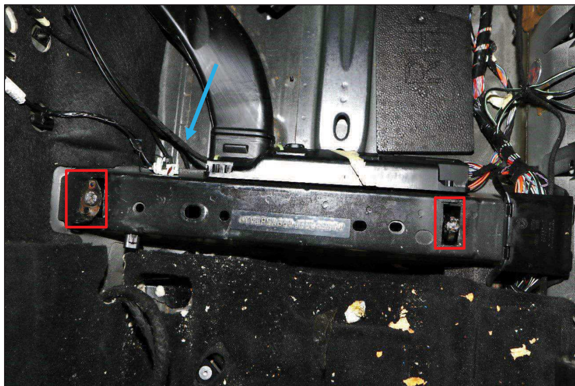
Figur 7. Krockbalken passagerarsida fram. Låsanordningarna markerade med röda rektanglar. Kabel (S002) markerad med blå pil.
