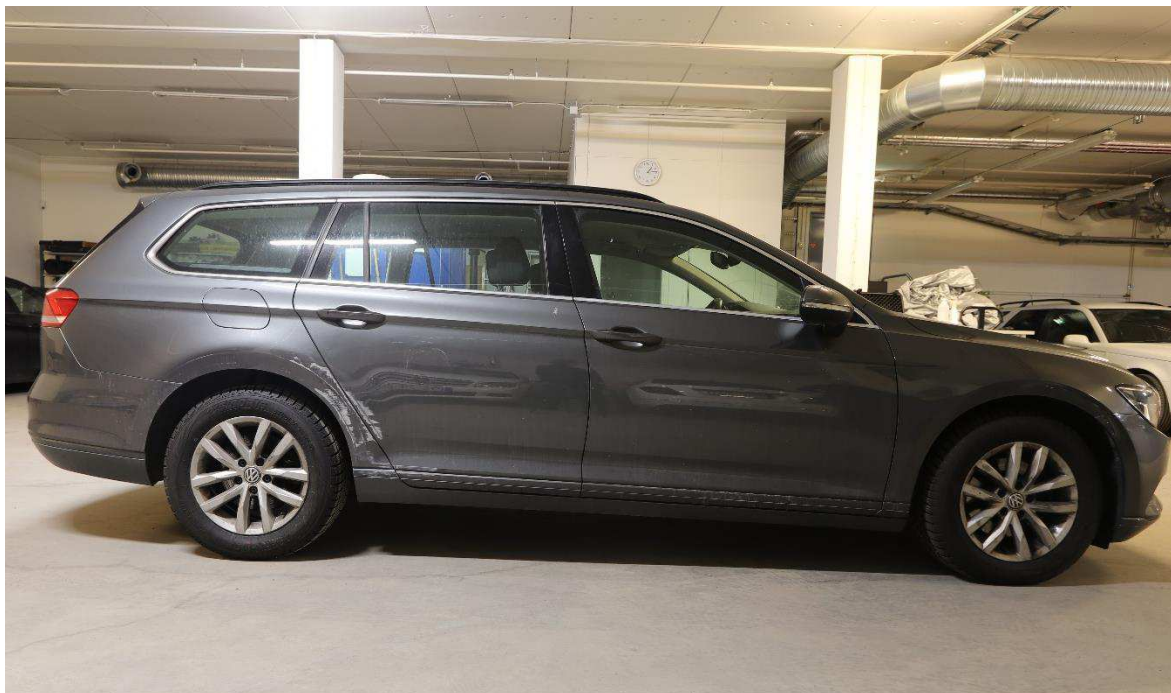
Figur 1. Höger sida av personbil JPX39T med en plåtskada till höger av det bakre hjulhuset som går över på baksörren.
