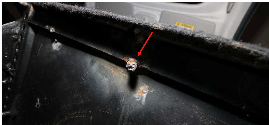
Figur 9. Foto av luckans undersida. Svetsningen som satt på motsatt sida av låsanordningen är markerad med röd pil.
