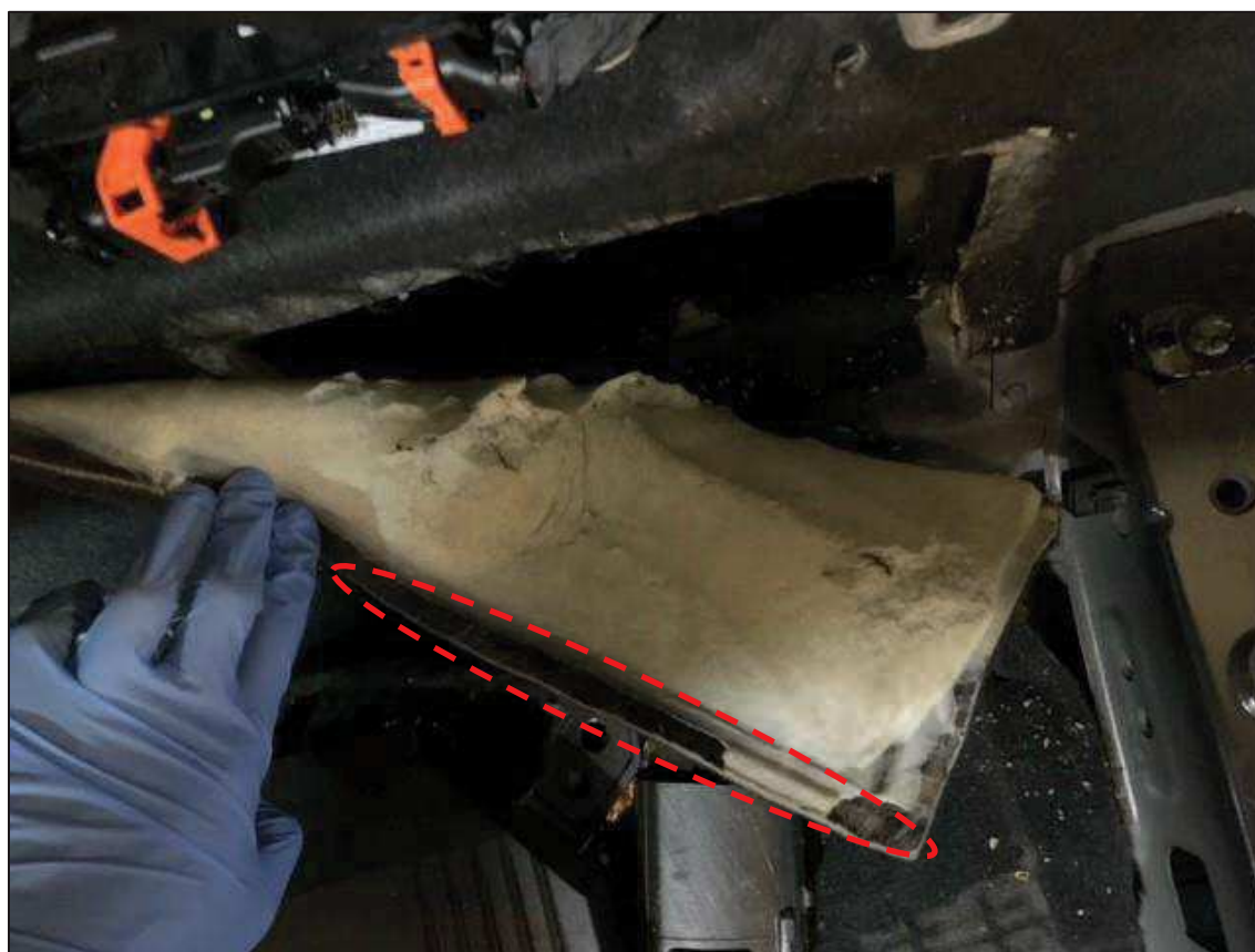
Figur 5. Insidan av mittkonsolens inredningsmatta, passagerare sida fram. Markerat med röd streckad elips är ytan som topsades (S003).
