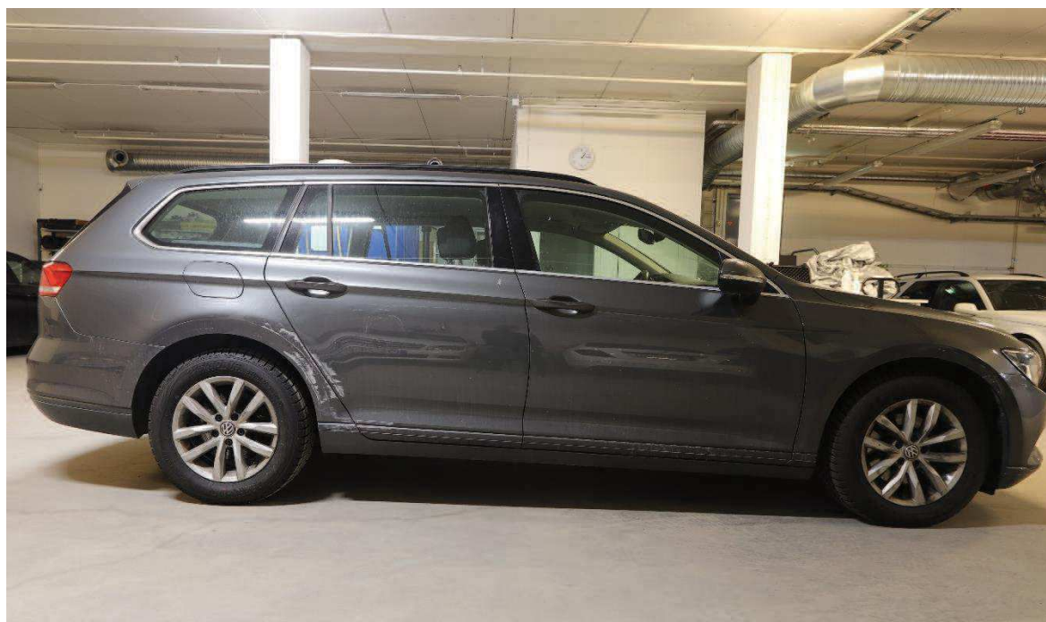
Figur 1. Höger sida av personbil JPX39T med en plåtskada till höger av det bakre hjulhuset som går över på bakhjulet.
