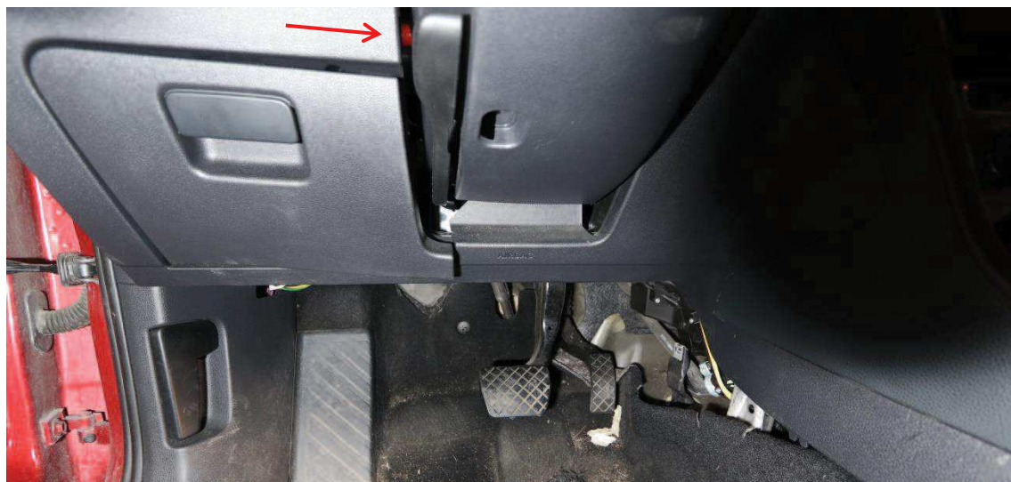
13. Den röda knappen (pilmarkerad) skymtar till vänster om spaken som lösgör ratten för justering i höjdled.
