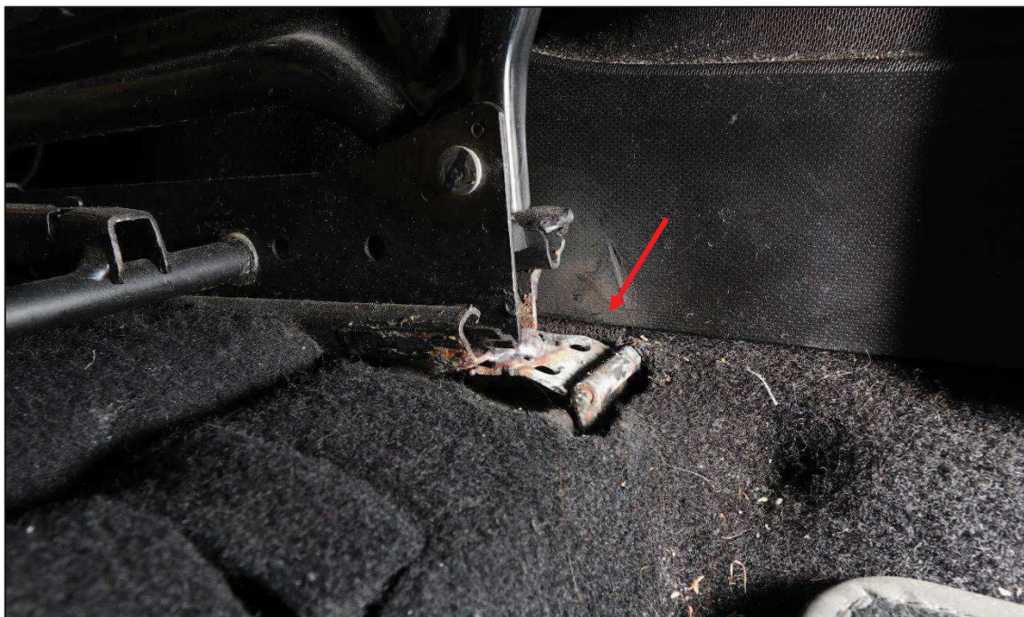
Figur 7. Foto av passagerarsätets främre vänstra sätesfäste, sett i fordonets färdriktning. Den röda pilen markerar det monterade gångjärnet.
