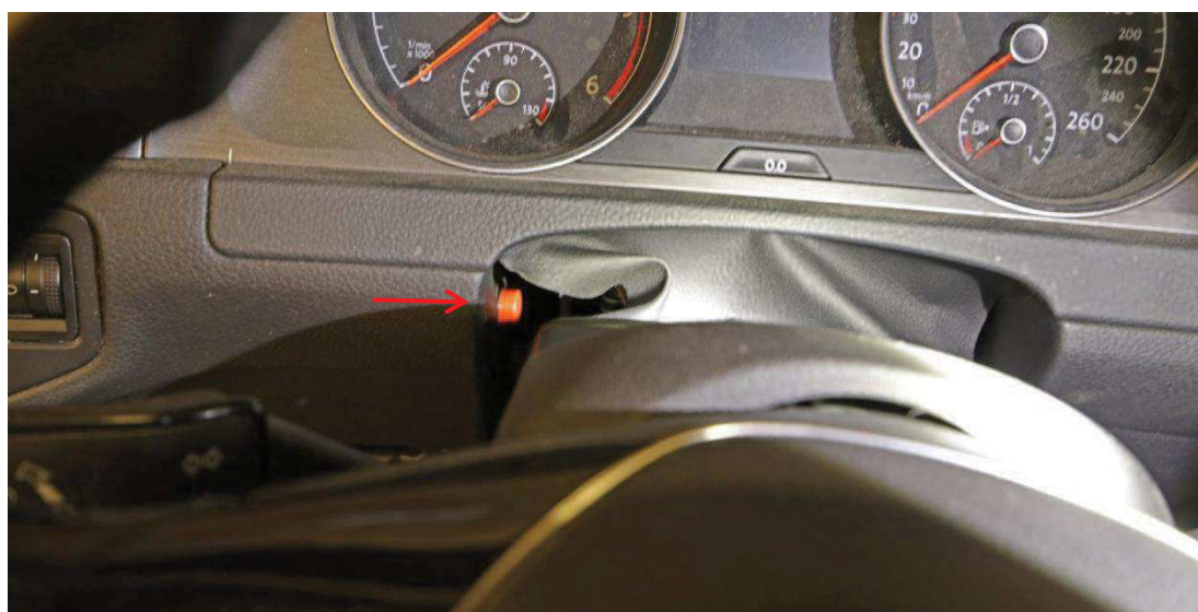
14. Den röda tryckknappen fotograferad från förarsätet. Damasken har dragits åt sidan och ratten har ställts i sin lägsta position för att synliggöra tryckknappen.
