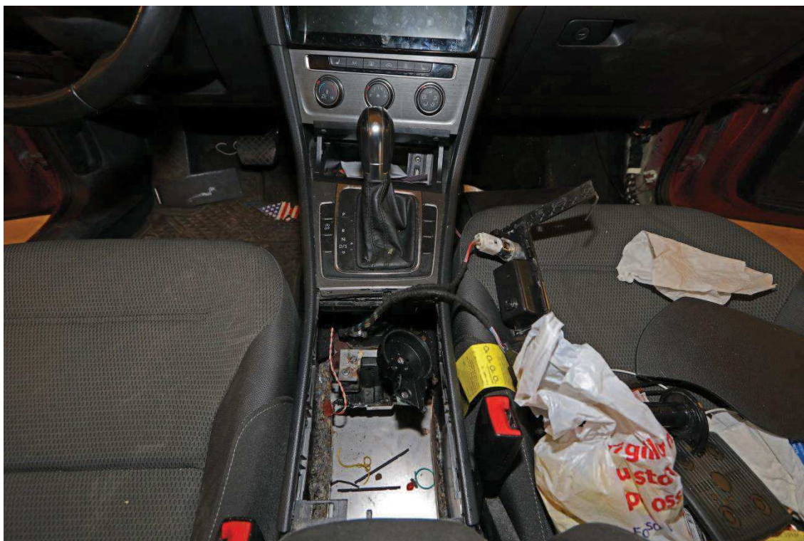
5. Lönnfacket/uppsågat utrymme fotograferat från baksätet. En del av mugghållaren sitter fast. Cellplasten är borttagen så att plåtgolvet blottlagts.
