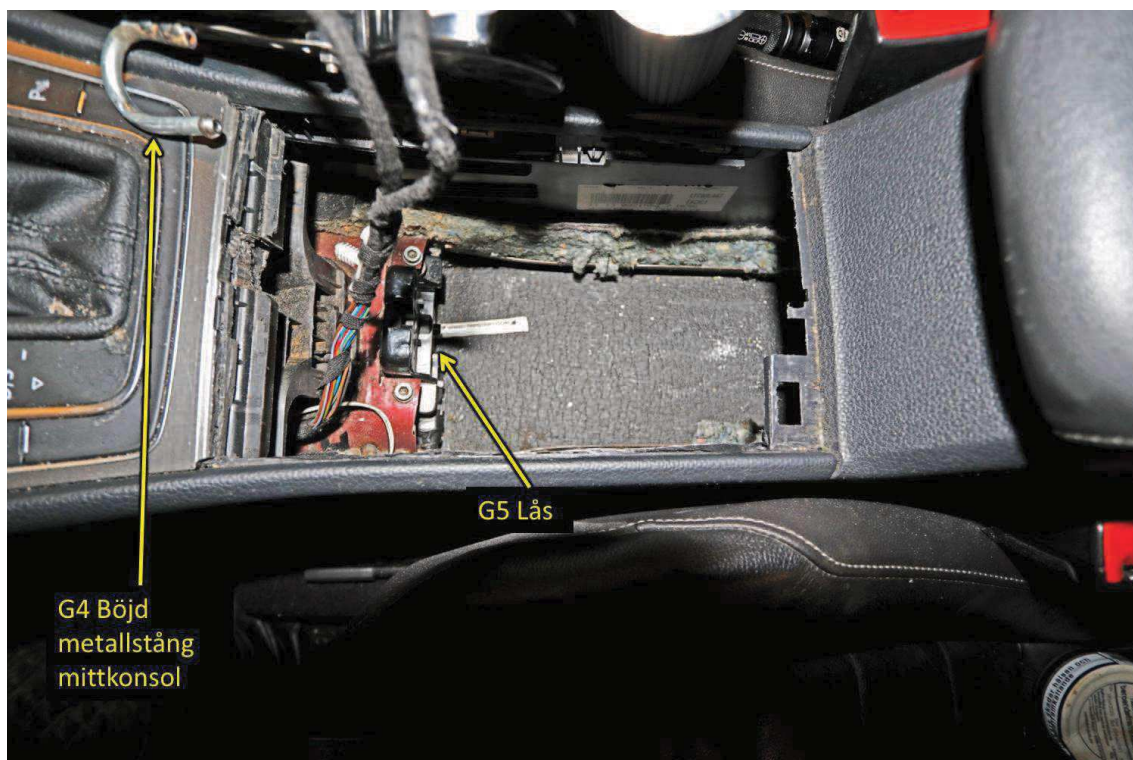
Figur 7: Bilden visar mittkonsolen efter det att den lyfts upp. Till vänster syns metallstången, gick ned i låset som satt monterad i det dolda utrymmet.
