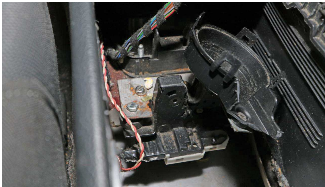
6. Låset och en fastsittande del av den sönderbrutna mugghållaren.
