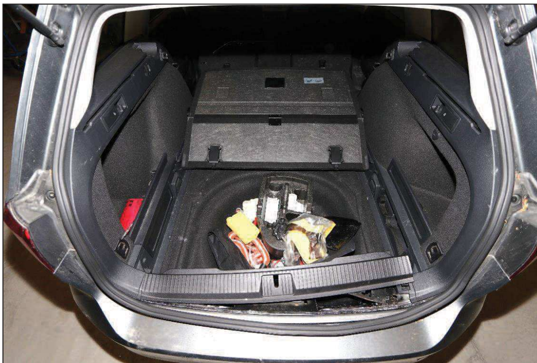
Figur 12. På denna bild visas lönnfacket i stötfångaren bak med plastkåpan delvis fastmonterad. Under plastkåpan döljer sig lönnfacket.
