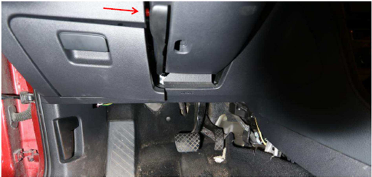
13. Den röda knappen (pilmarkerad) skymtar till vänster om spaken som lösgör ratten för justering i höjdlid.
