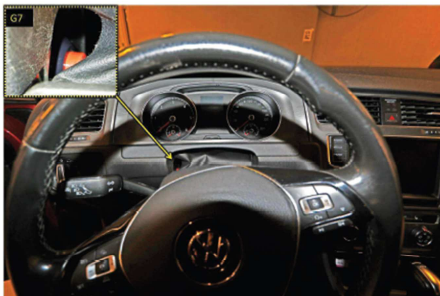
Figur 6: Bilden visar ratten som har tiltats nedåt och till vänster om rattstången syns en röd knapp.
