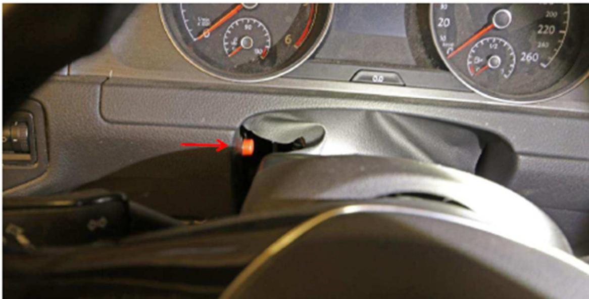
14. Den röda tryckknappen fotograferad från förarsätet. Damasken har dragits åt sidan och ratten har ställts i sin lägsta position för att synliggöra tryckknappen.
