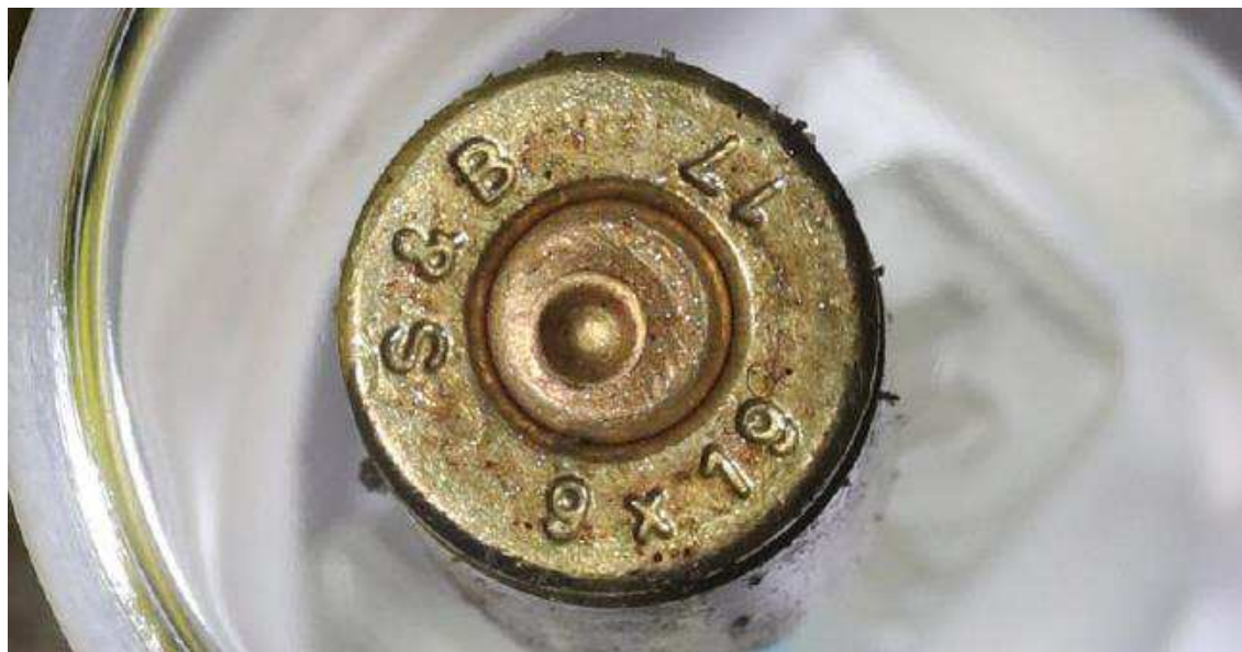
Figur 6. Närbild på hylsbotten med texten "S&B 9x19 17". Alla tre hylsor som säkrades från brottsplatsen hade samma märkning och tändspetsintryck.
