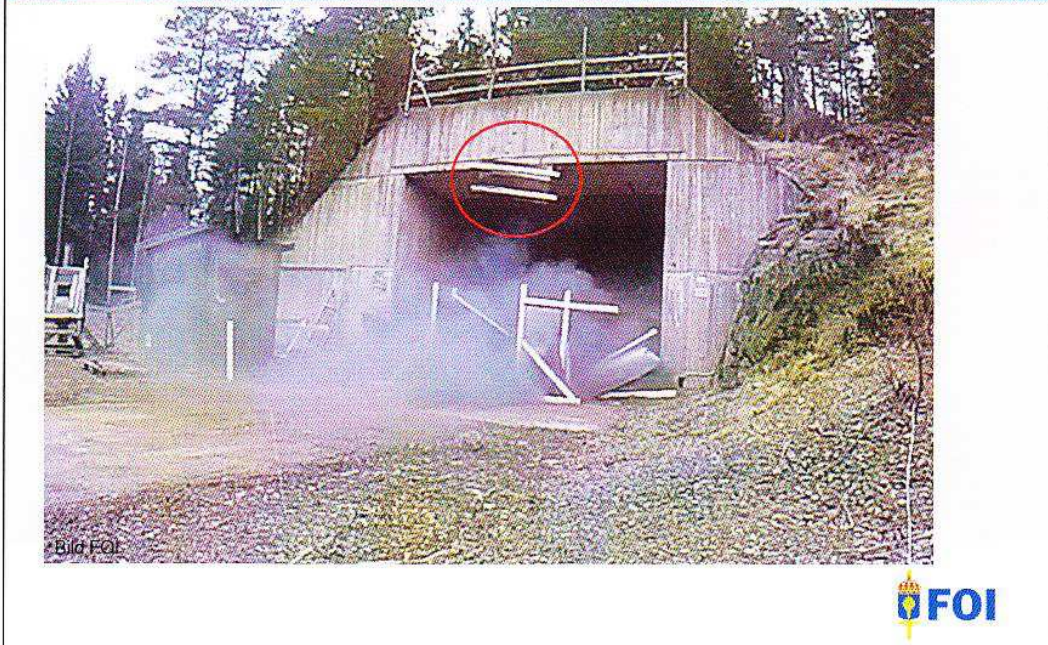
Figur 7: Granaten detonerar i målplåten, av trycket kastas en vittnesplåt flera meter upp i luften.
