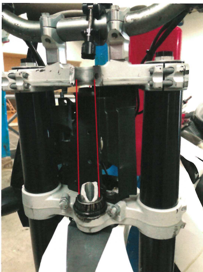
Bild 5, Skadan på styrinrättning som gjort att fordonet separerade.
