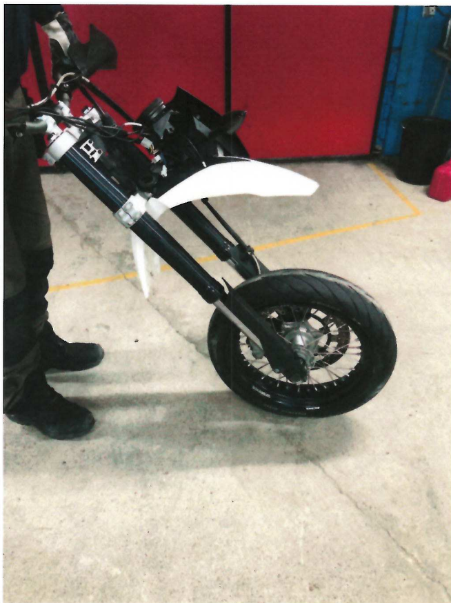
Bild 9, Fordonets styre, framgaffel, framhjul med fungerande broms m.m., som separerat från resten av fordonet.
