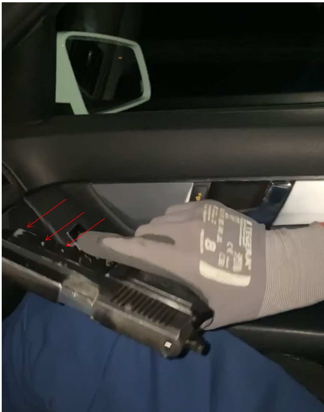
Bild 1. Pistolen när den hålls i höger hand. Ett urval av förslitningsskadorna markerade med pilar.
