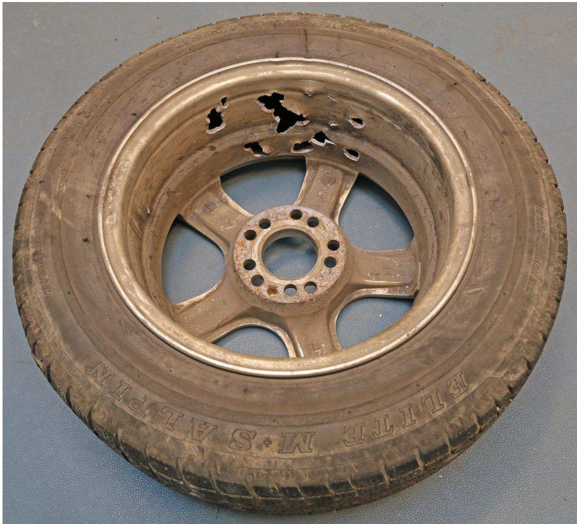
Bild 22: Ett av de beskjutna däckerna där skadorna syns på fälgens insida.
