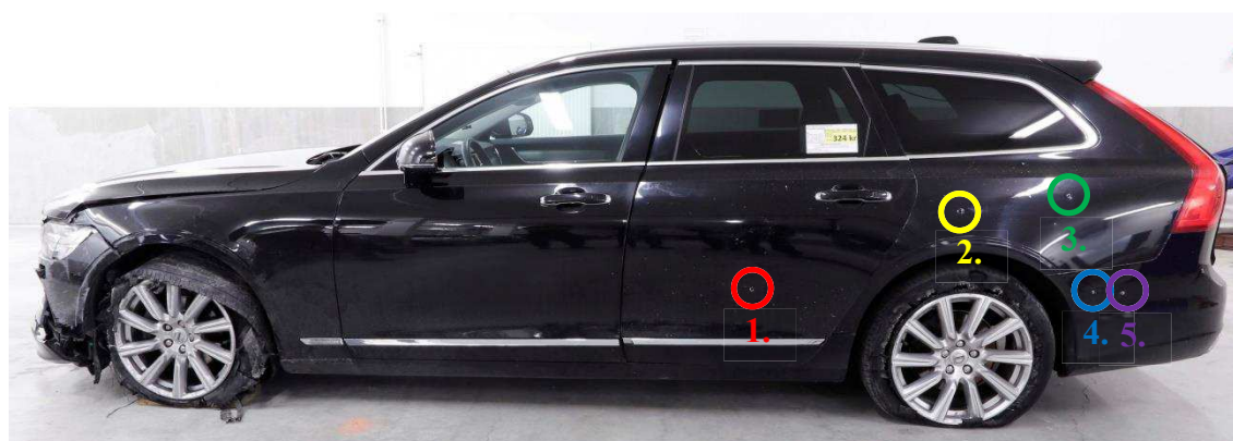
Figur 2. Skadorna på höger sida numrerade och markerade med färgade cirklar.
