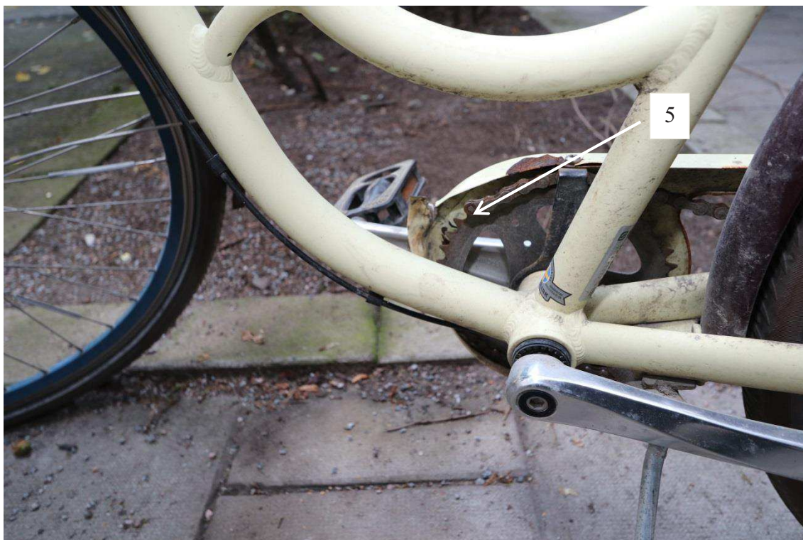
Bild 16: En skottskada från en kula i det främre kugghjulet tillhörande den fjärde cykeln från vänster.
