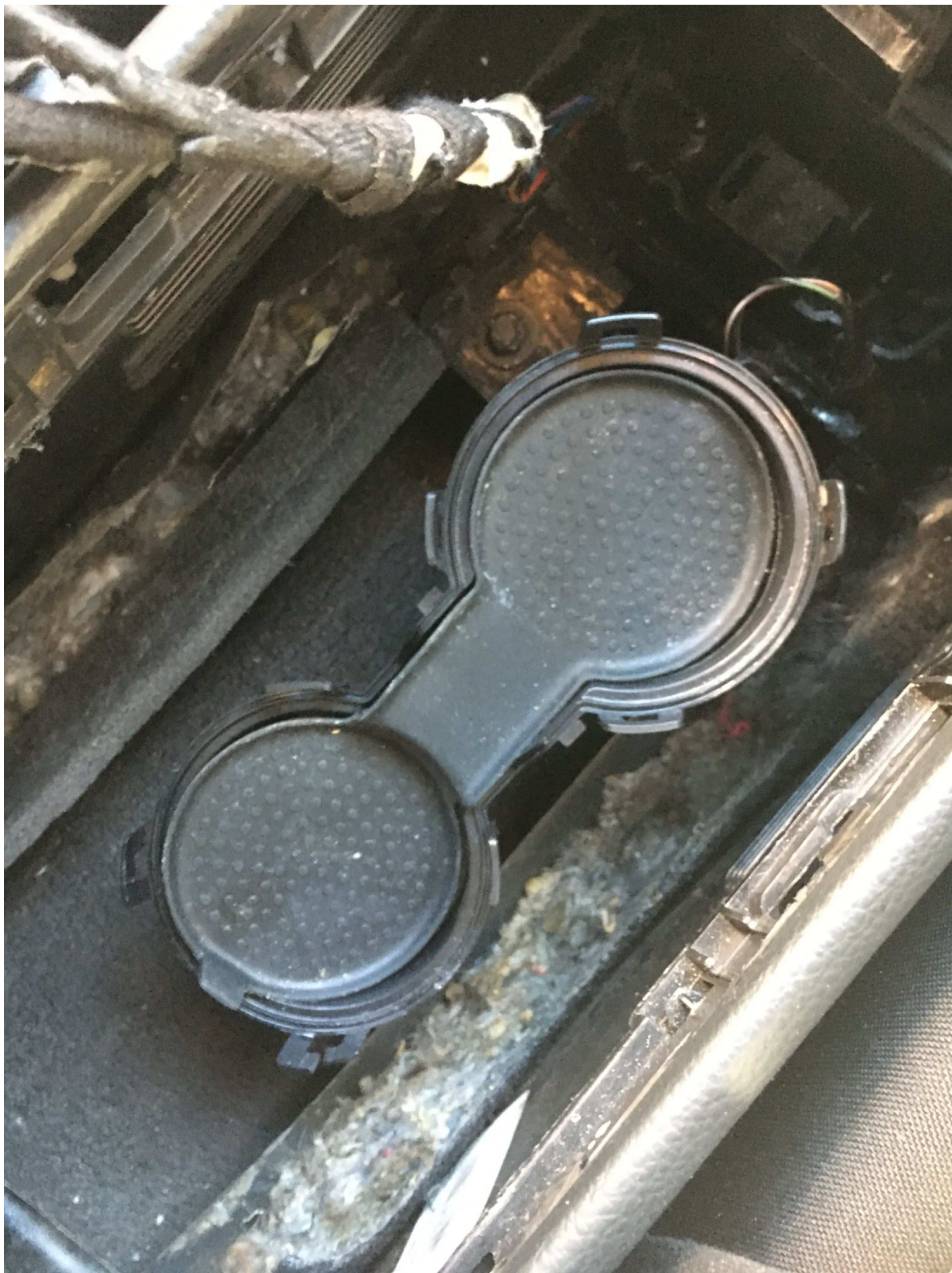
8. Mittkonsolen (bild 5) med ramen och övre delen av drickahållaren bortmonterad. Undre delen av drickahållaren kvar på plats, med plastskydd i
