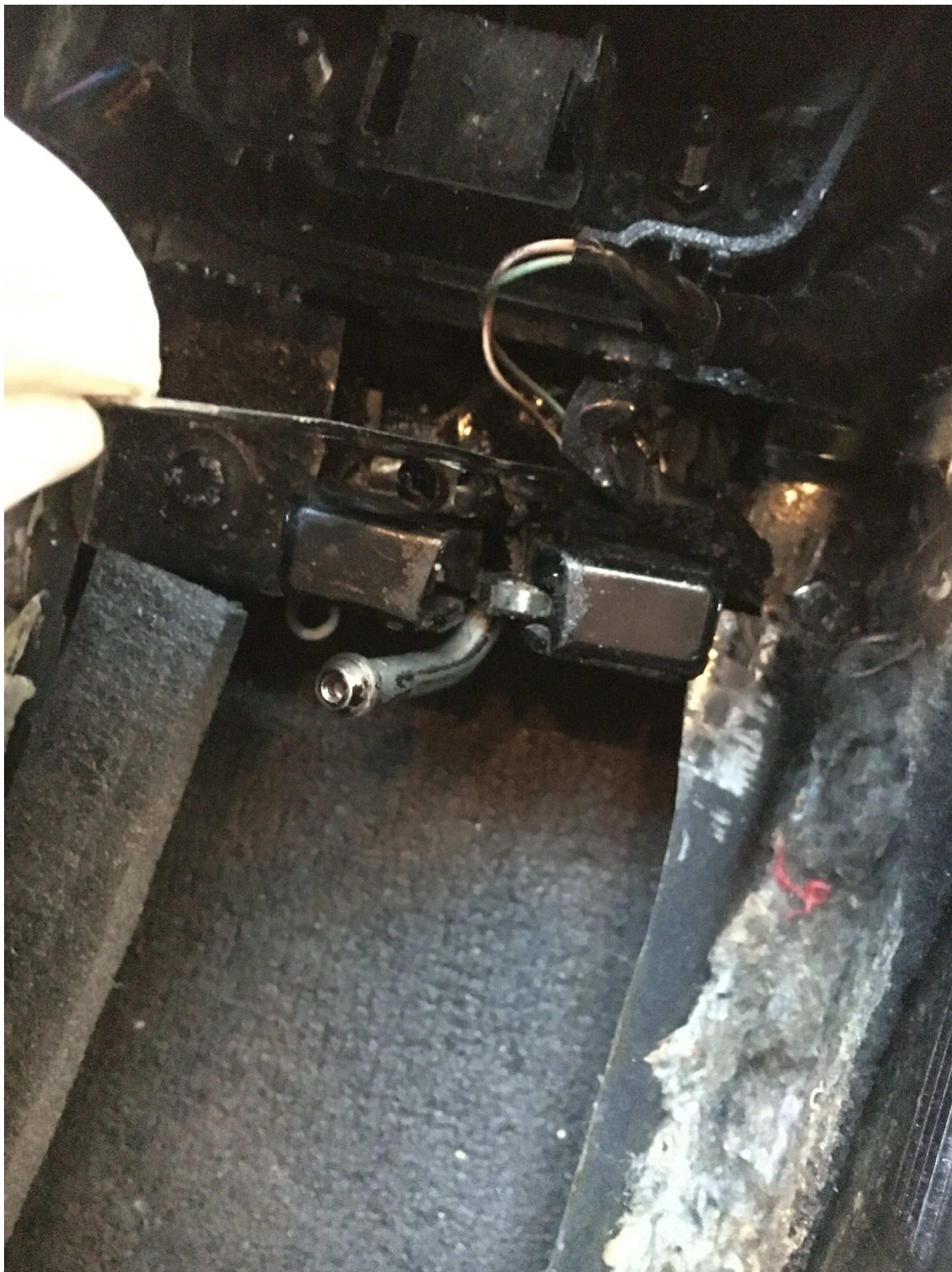
18. Mittkonsolen (bild 10) med ramen och övre samt undre delen av drickahållaren bortmonterad, med låsplattan bortvriden
