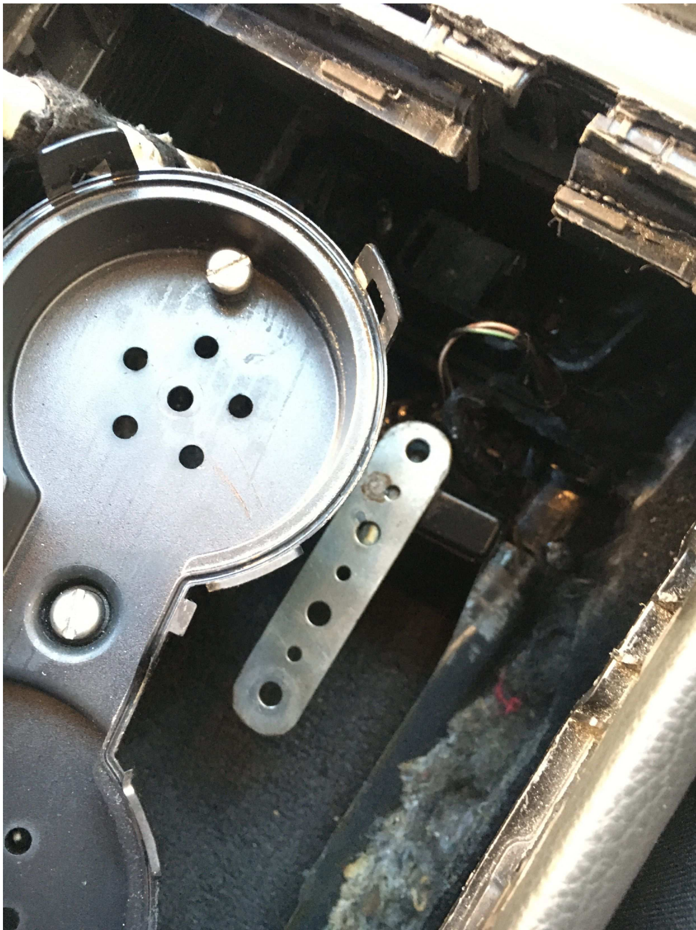
12. Mittkonsolen (bild 9) med ramen och övre samt undre delen av drickahållaren bortmonterad, med låsplattan i bakgrunden och den bortmonterade undre delen av drickahållaren i förgrunden
