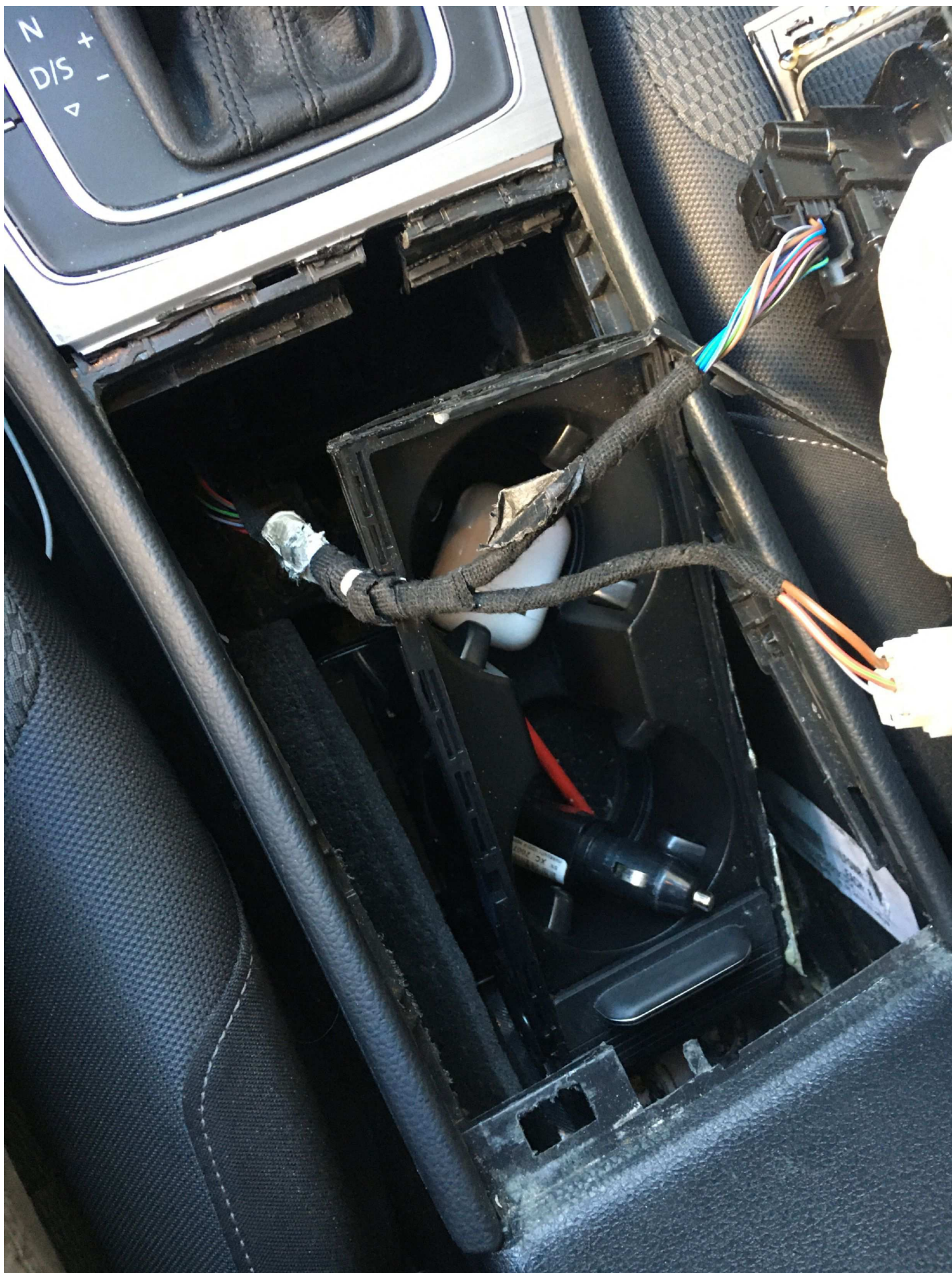
3. Mittkonsolen (bild 2) med bortmonterad ram och hela drickahållaren kvar
