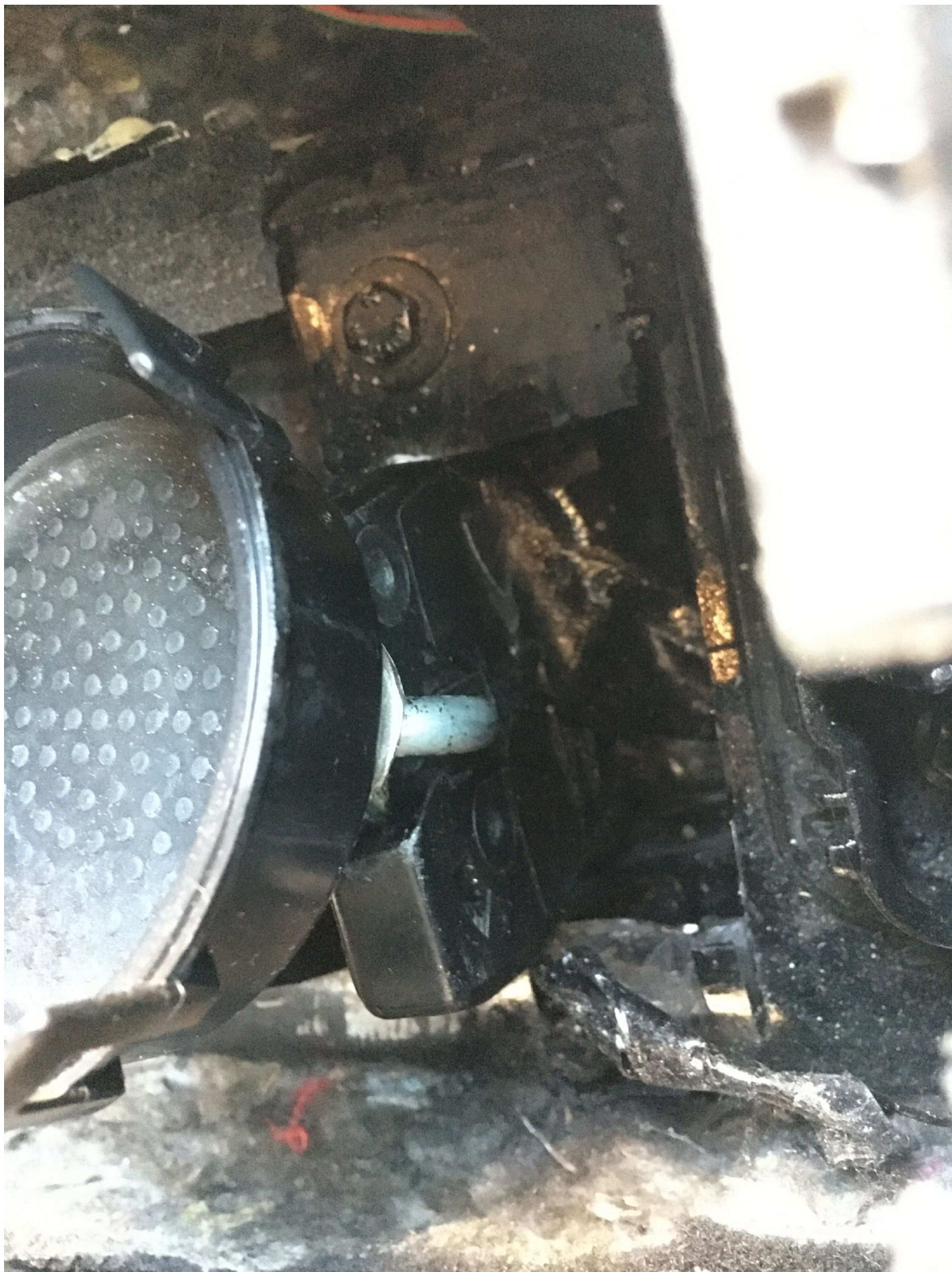
9. Mittkonsolen (bild 6) med ramen och övre delen av drickahållaren bortmonterad. Närbild på låsanordningen som fäster en bricka som sitter fast i undre delen av drickahållaren
