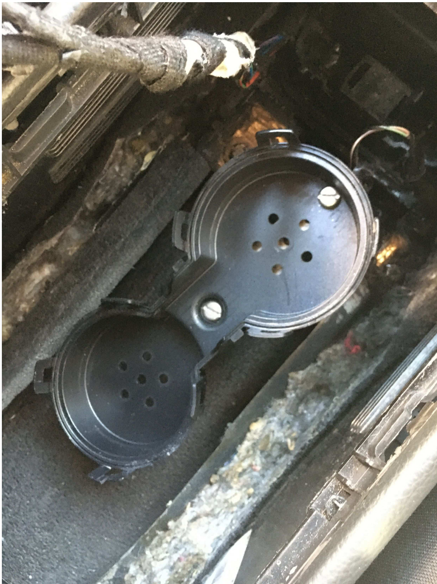
10. Mittkonsolen (bild 7) med ramen och övre delen av drickahållaren bortmonterad. Undre delen av drickahållaren kvar på plats, med plastskydd borttaget
