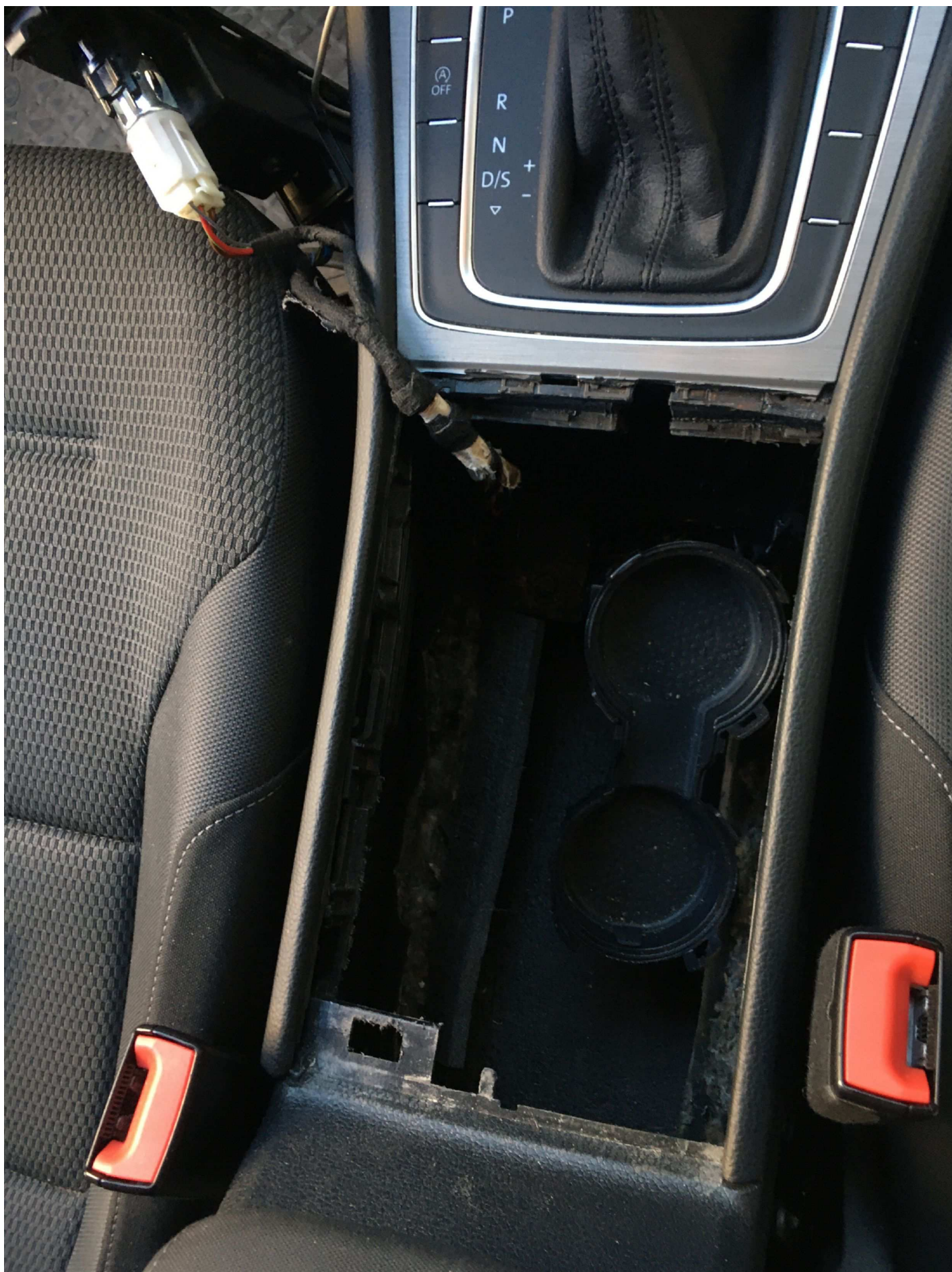
7. Mittkonsolen (bild 4) med ramen och övre delen av drickahållaren bortmonterad. Undre delen av drickahållaren kvar på plats
