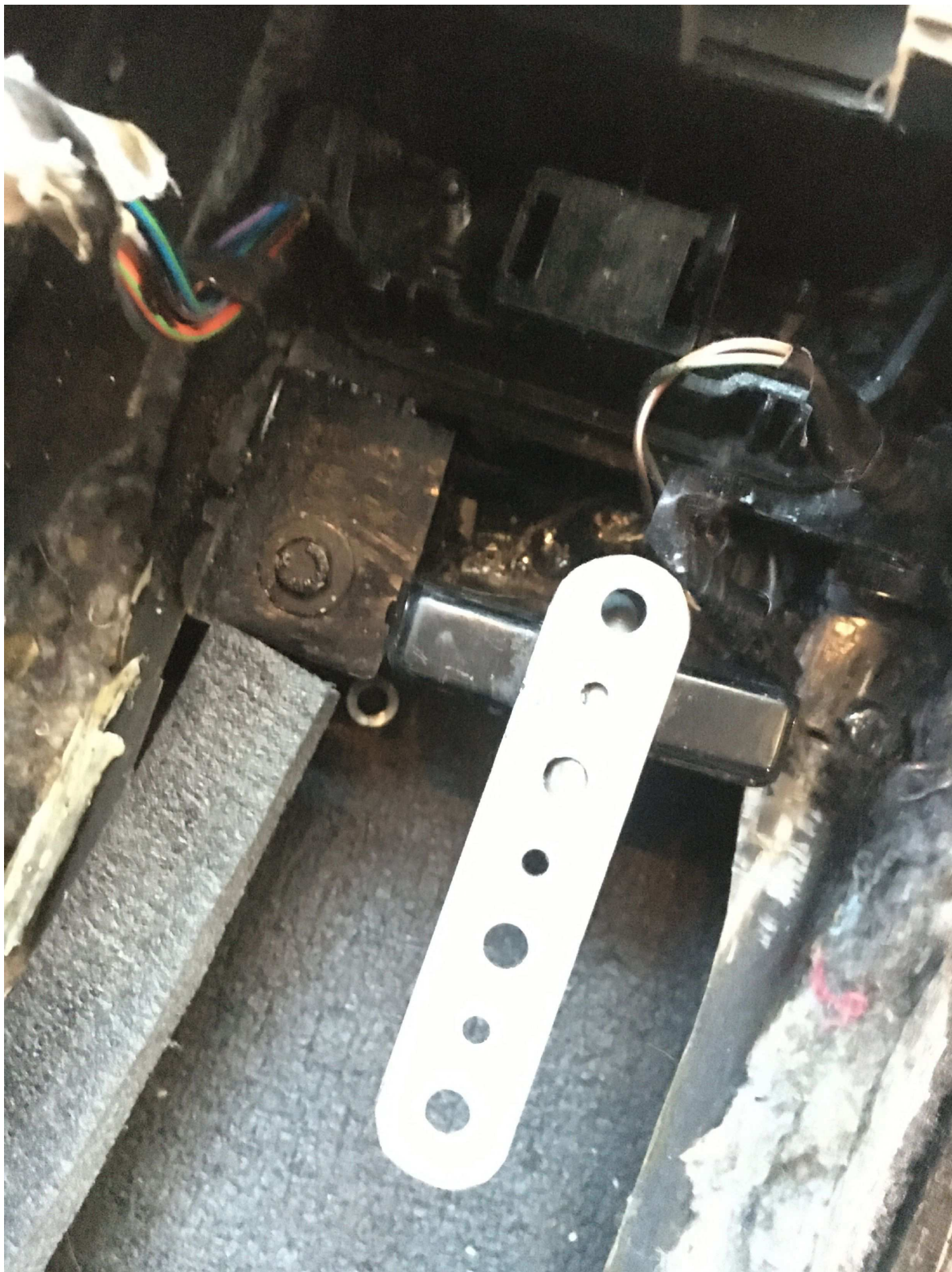
11. Mittkonsolen (bild 8) med ramen och övre samt undre delen av drickahållaren bortmonterad.
