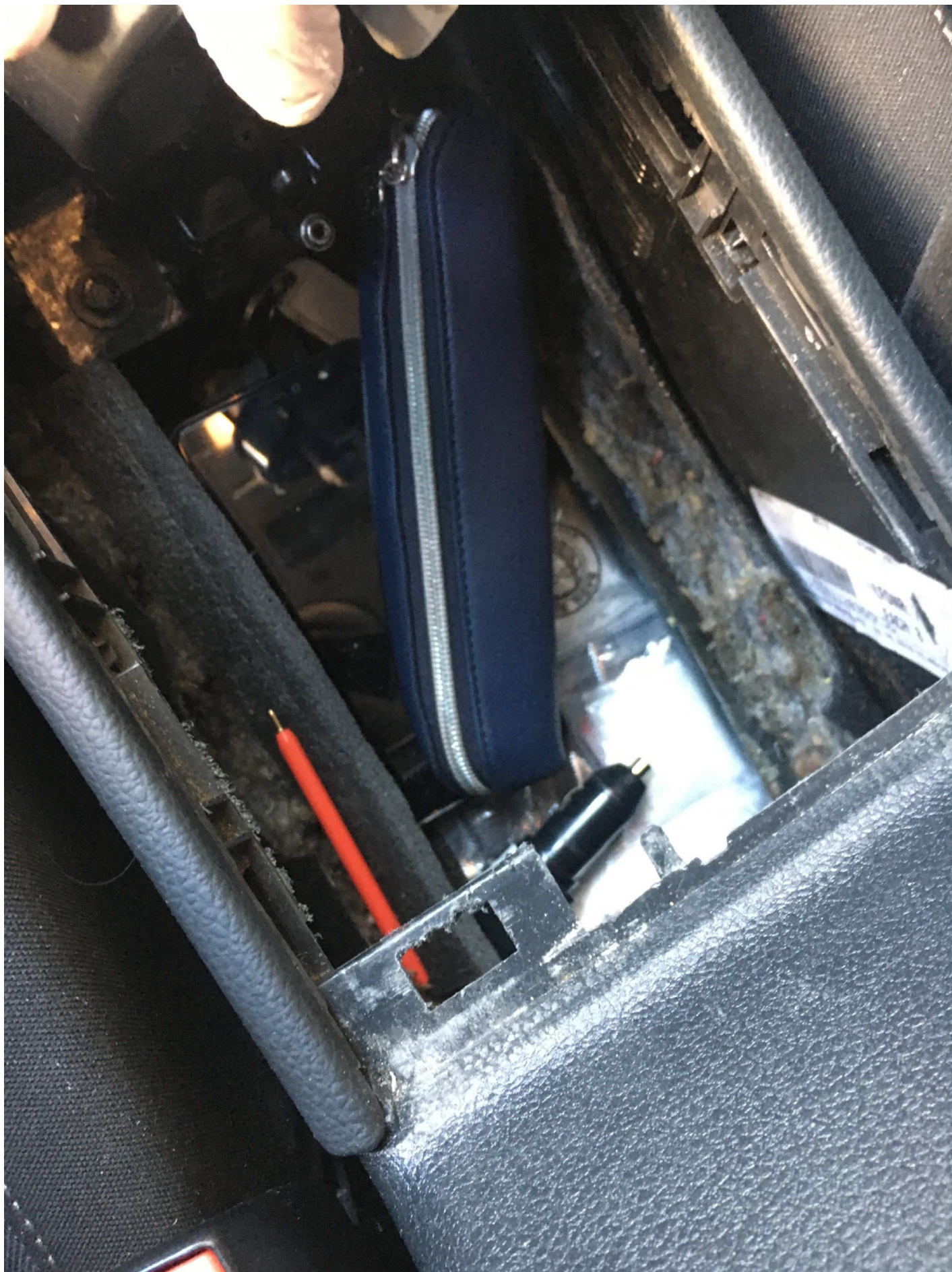
4. Mittkonsolen (bild 3) med bortmonterad ram och halva drickahållaren borta och underdelen av drickahållaren bortvriden, med beslag BG72006-31, BG72006-34, BG72006-5 och BG72006-6
