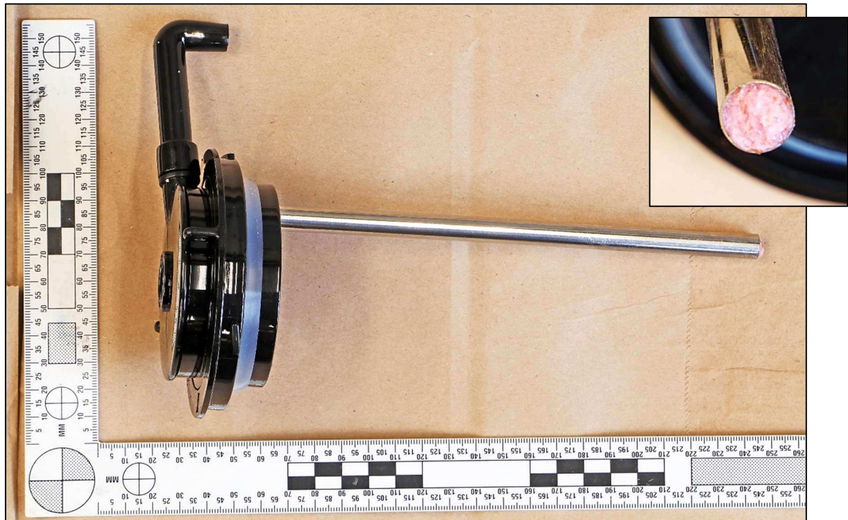
Figur 7. Pumpen. Inflikad bild visar misstänkt rosa sprängämne i röret sett underifrån.
