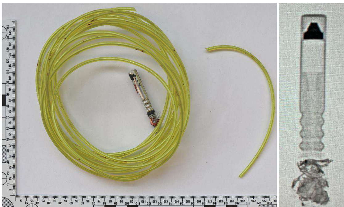
Figur 1 och 2. Sprängkapseln varifrån SM12494-24 har säkrats samt röntgenbild
