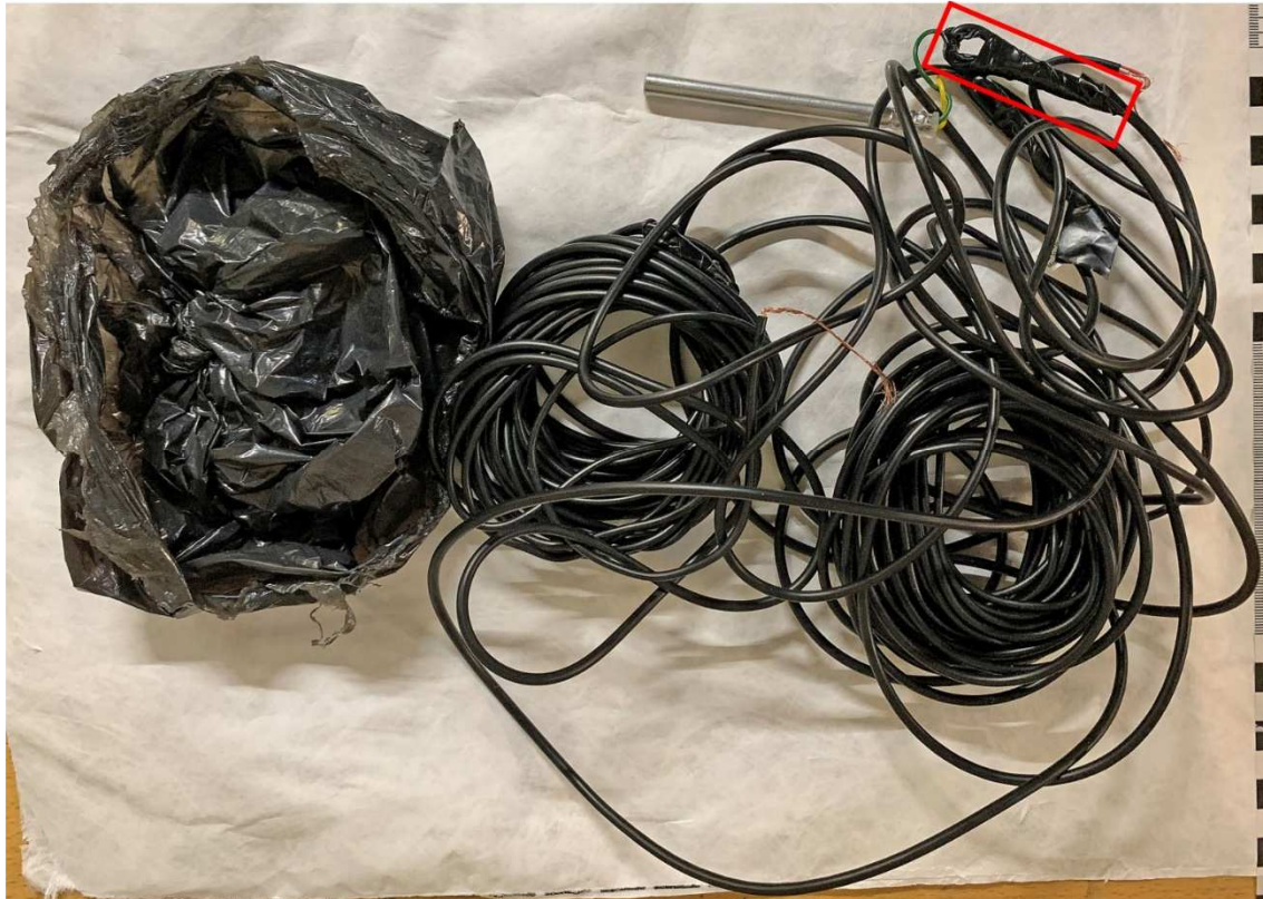
Bild 1: Beslagtagn elsprängkapsel med troligen ihopskarvade elkablar.
