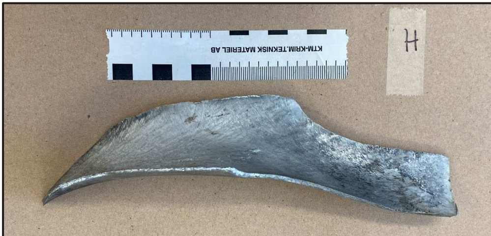
Exempel på splitter från en kolsyreflaska med krut som exploderat.
