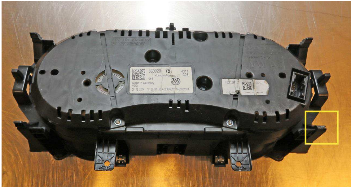
Figur 3. Baksidan av instrumentpanelen/hastighetsmätaren. En trasig plastdetalj markerad med gul fyrkant.
