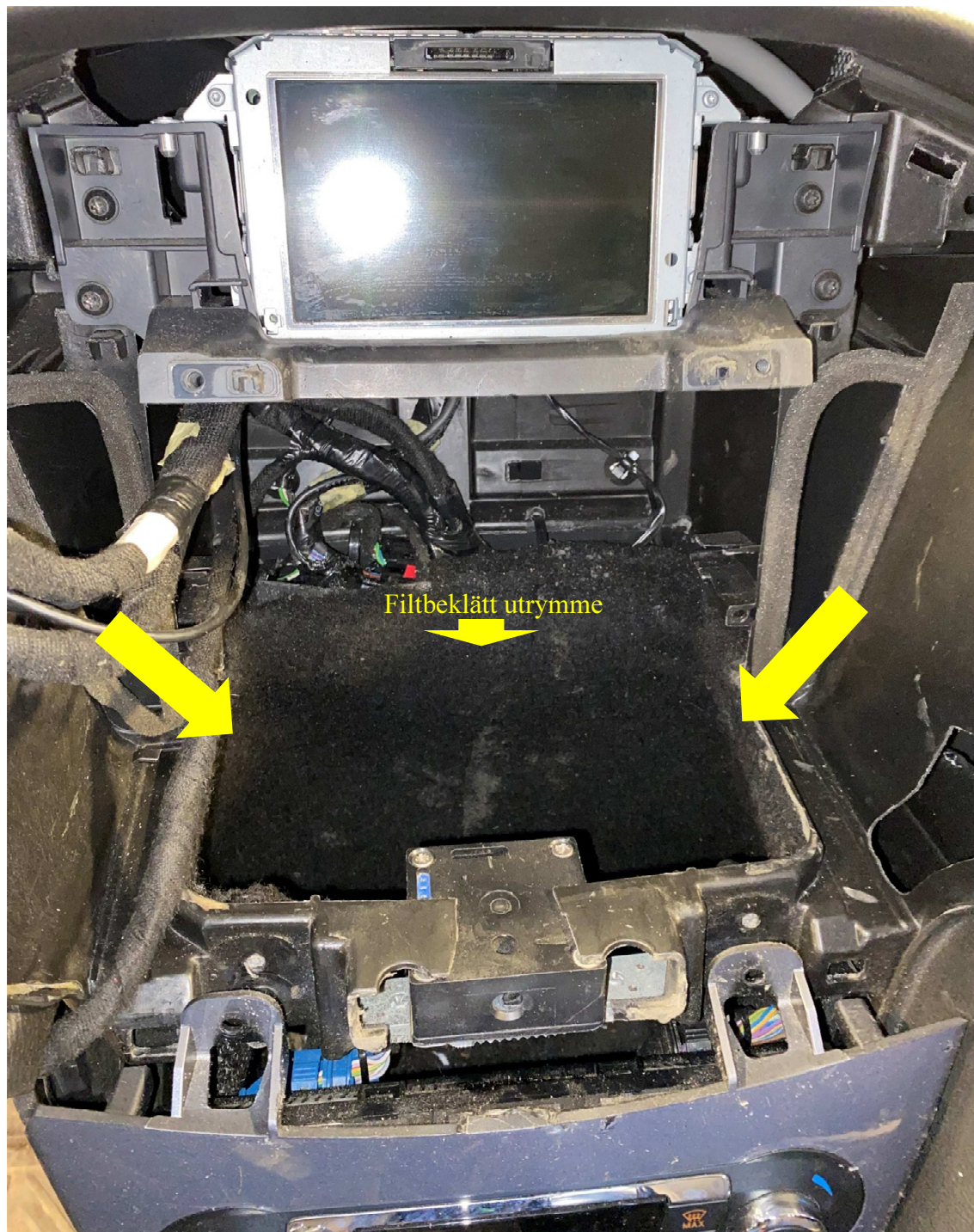
Figur 10. Vy framifrån av det filtbeklädda utrymmet som är markerat med pilar. Här är radion bortmonterad.
