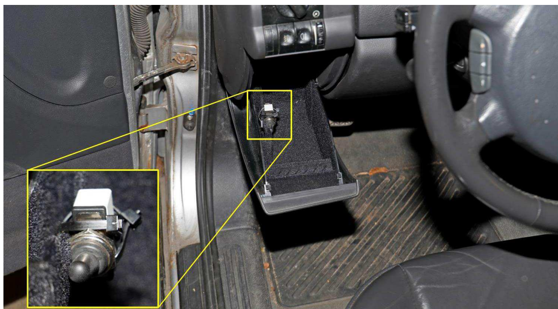
Figur 10. Bilden visar strömbrytarens placering i förvaringsutrymmet. Detaljbilden visar brytarens montering i utrymmet.
