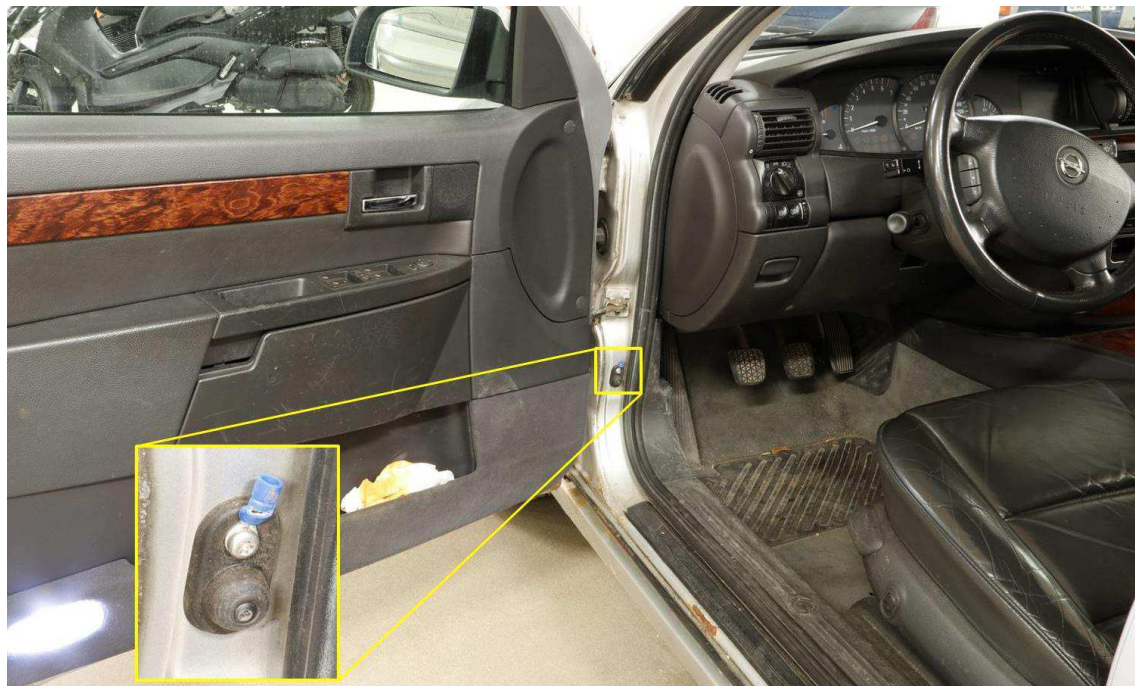
Figur 9. Bilden visar kabelskons placering i i förardörrens öppning. Förstoringen visar kabelskon monterad i förardörrens strömbrytare till innerbelysningen.
