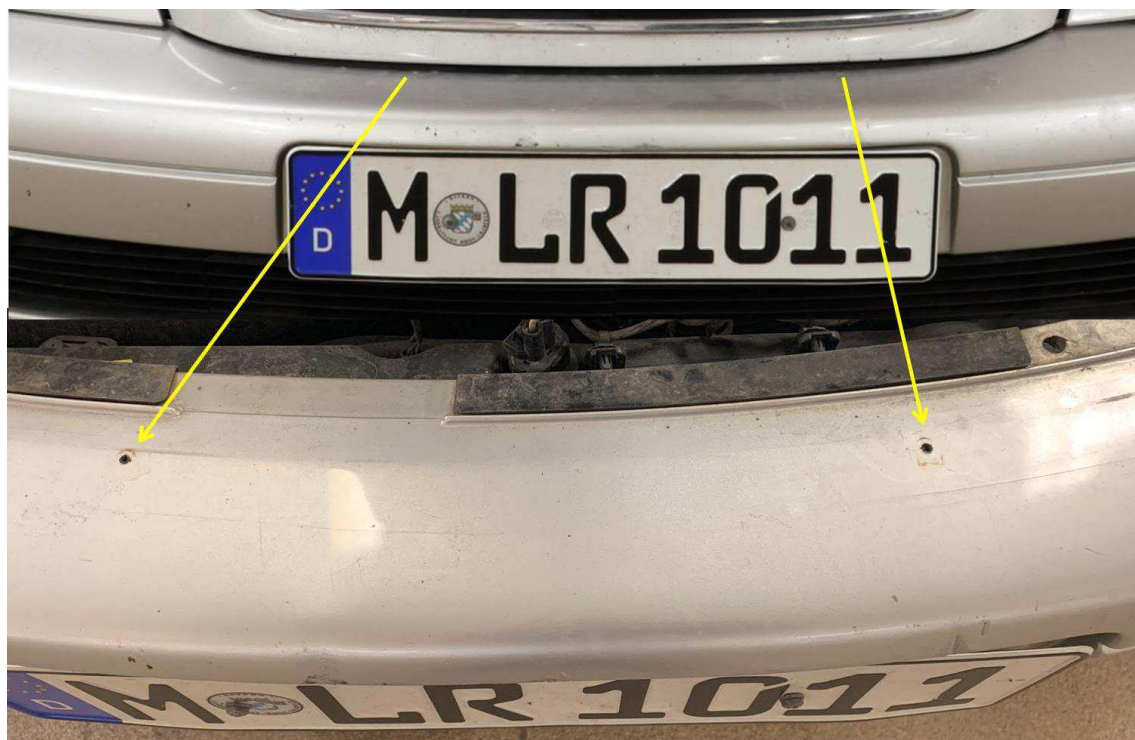
Figur 4. Bildmontage där den övre bilden visar del av den främre stötfångaren. Pilarna visar hålets placering. Den nedre bilden visar hålets utformning i detalj.
