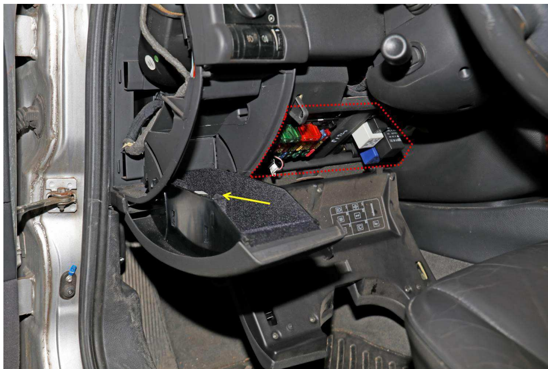
Figur 11. Bilden visar förvaringsfacket med strömbrytaren markerad med pil och placeringen av fordonets säkringar under ratten markerade.
