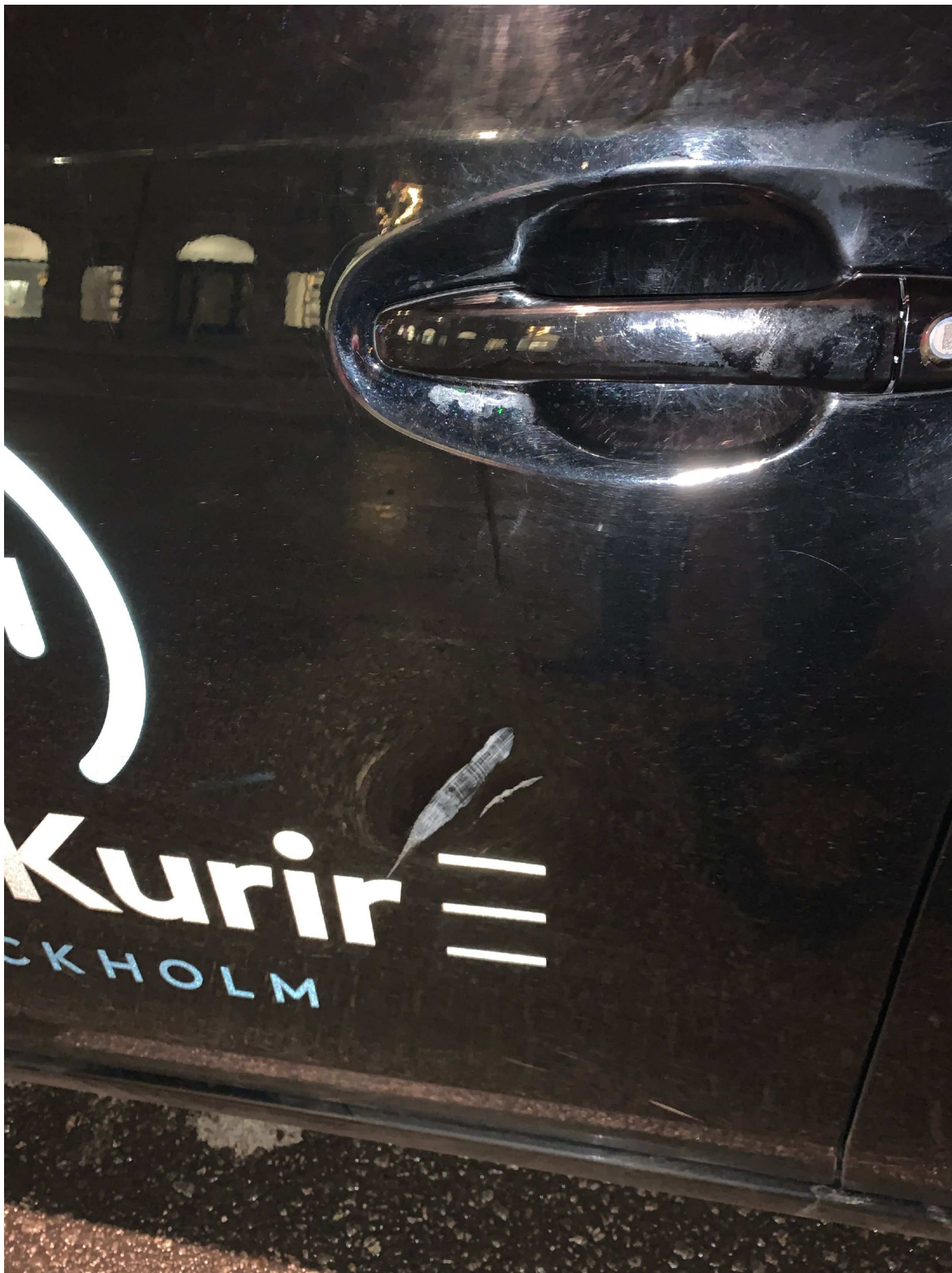
1. Förardörr på fordon XUP010 där släggan har träffat och skadat dörren strax ovanför texten.
