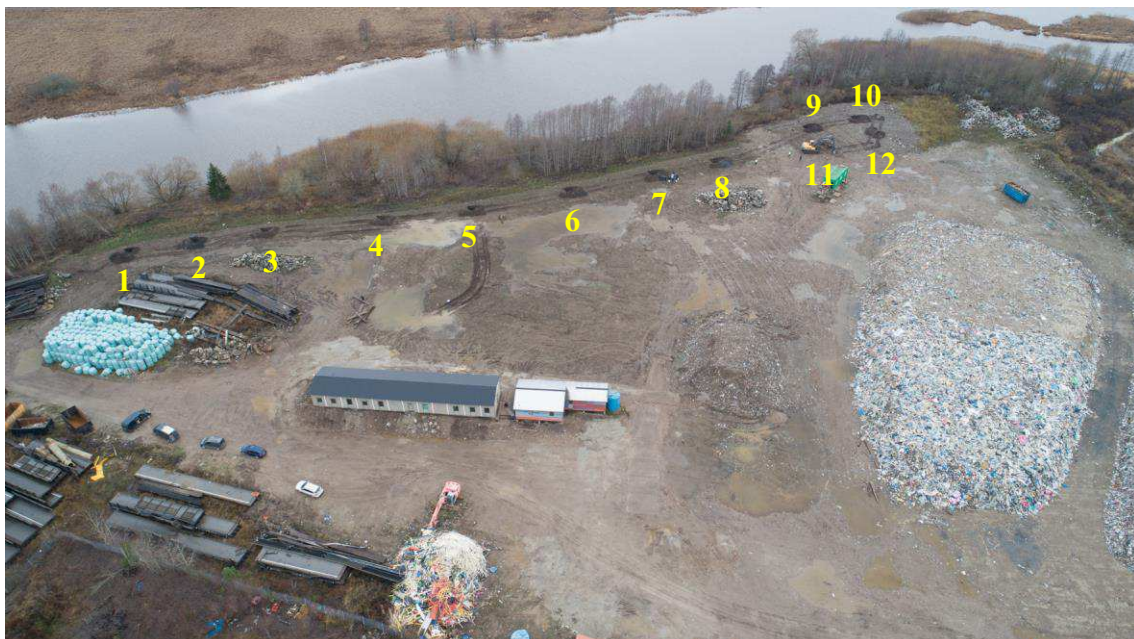
Figur 13. Tolv uppgrävda gropar varifrån två samlingsprover med jord, tre askprover samt ett vattenprov säkrats. Groparna har märkts upp med markering 1-12.
