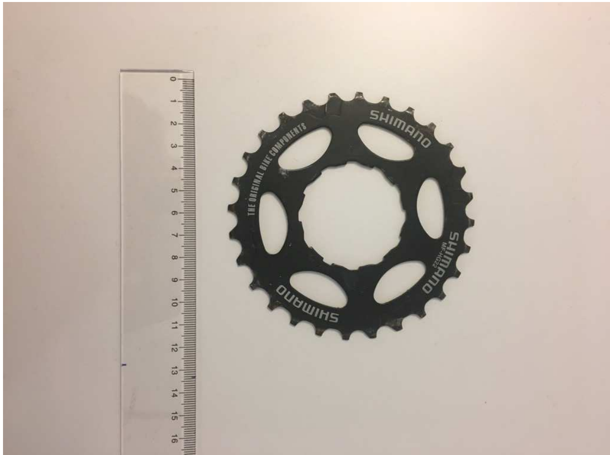
Foton på den s k "Kaststjärnan" som är ett kedjedrev till en cykel.
