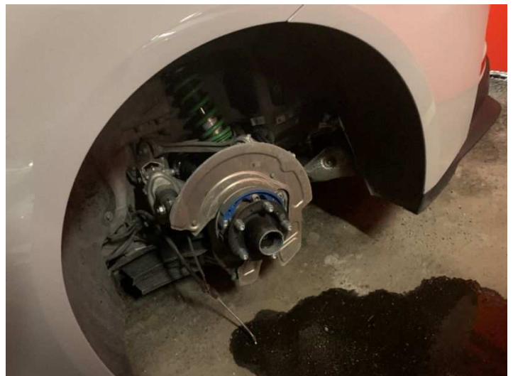
8. Porsche DXD 23K, närbild där hjul, bromsok, bromsskiva samt bromsbelägg saknas.
